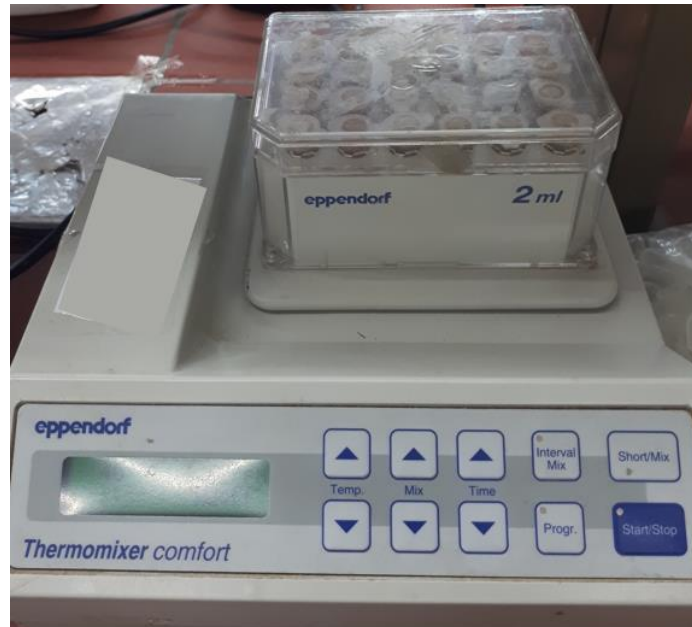
Εικόνα 27: Θερμοστατούμενος αναδευτήρας (thermomixer)
