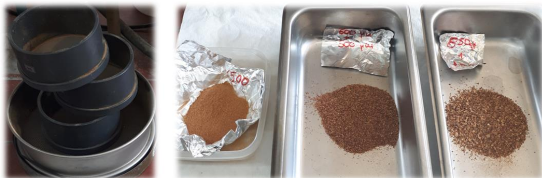
Εικόνα 25: Κοσκίνιση αποξηραμένου περικαρπίου του καρπού R. canina L. και 3 διαφορετικά εύρη κοκκομετρίας: <500 \mu\text{m} , 500-600 \mu\text{m} και 850-1000 \mu\text{m} .
