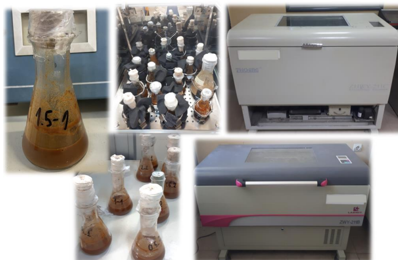
Εικόνα 26: Πειράματα μελέτης επίδρασης στην EYE αναλογίας στερεού-υγρού και ενζυμικού φορτίου
