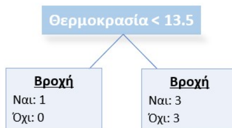
Σχήμα 2.9: Δένδρο για την μεταβλητή ‘Θερμοκρασία’ κάνοντας χρήση της πρώτης μέσης τιμής (13.5).
