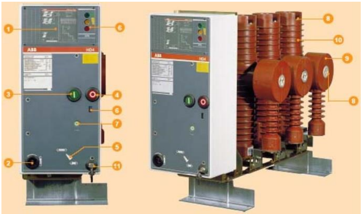
Εικόνα 42. Βασικά στοιχεία Δ/Ι με SF 6 [1-Στοιχεία Η/Ν προστασίας, 2-Άξονας τάνυσης του ελατηρίου, 3-Κουμπί ενεργοποίησης Η/Ν, 4-Κουμπί απενεργοποίησης Η/Ν, 5-Χρωματική ένδειξη λειτουργίας ελατηρίου συμπιεσμένο (κίτρινο) και χαλαρό (άσπρο), 6-Ένδειξη πίεσης SF 6 και μηχανισμός κλεισίματος, 7-Ένδειξη λειτουργίας του Δ/Ι (Ο/Ι), 8-Ακροδέκτες, 9-Ελεγκτές ρεύματος των Η/Ν, 10-Πόλος του Δ/Ι, 11-Κλειδί μανδάλωσης, 12-Μετρητής λειτουργίας] [21]
