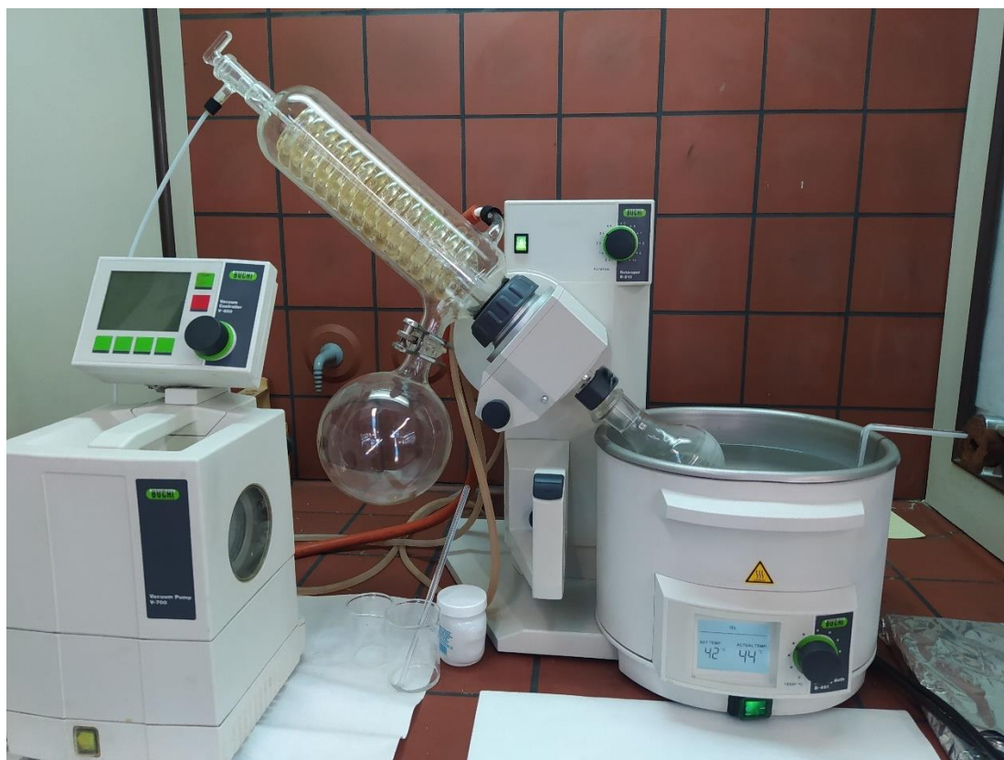
Εικόνα 18 Πειραματική διάταξη περιστροφικού εξατμιστήρα με συνδεδεμένη αντλία κενού.
