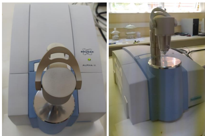
Εικόνα 22 Όργανο Platinum-ATR ALFA II Bruker.
