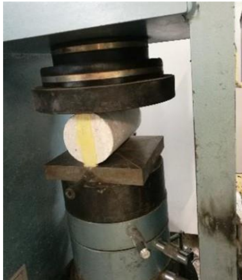
Εικόνα 10.7 Διάταξη εργαστηριακής δοκιμής διάρρηξης (Splitting strength test)
