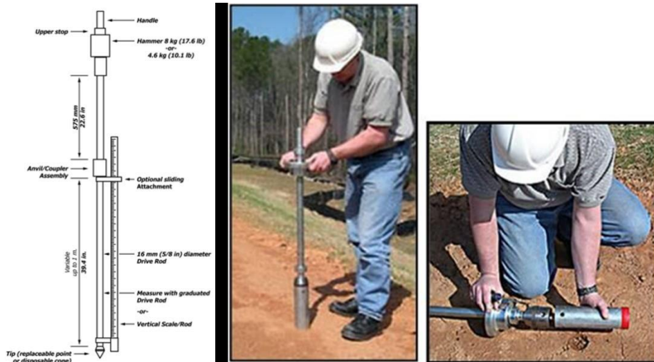
Εικόνα 2.20 Δοκιμή δυναμικού πενετρόμετρου κώνου (Dynamic Cone Penetrometer)
