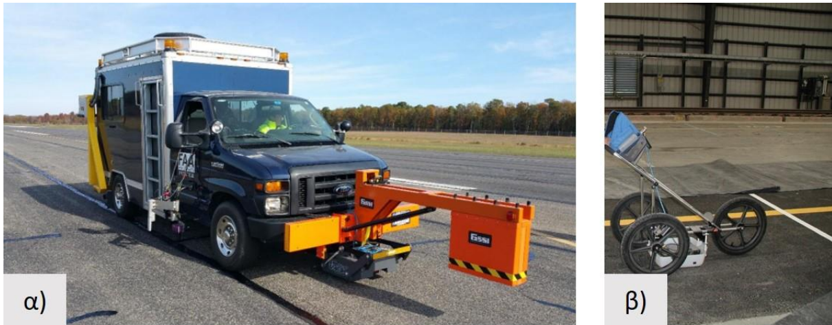
Εικόνα 2.18 α) Πομπός σε απόσταση από την επιφάνεια ελέγχου και β) πομπός σε πλήρη επαφή με την επιφάνεια ελέγχου
