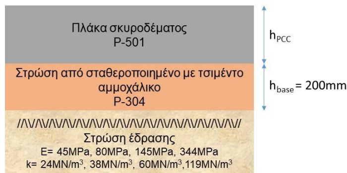
Εικόνα 9.43 Διατομή δύσκαμπτου οδοστρώματος
