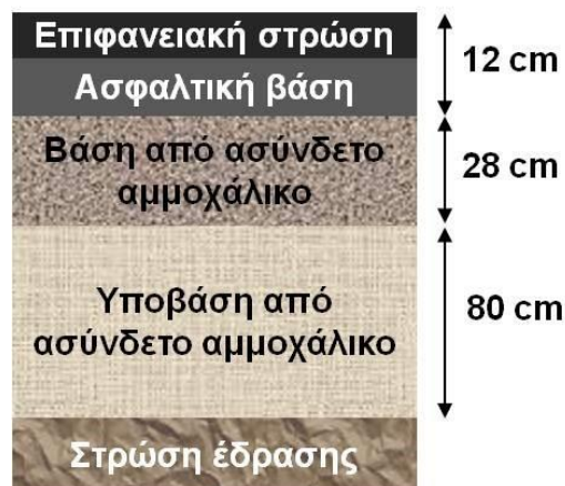
Εικόνα 11.3 Τυπική διατομή οδοστρώματος διαδρόμου Π/Α
