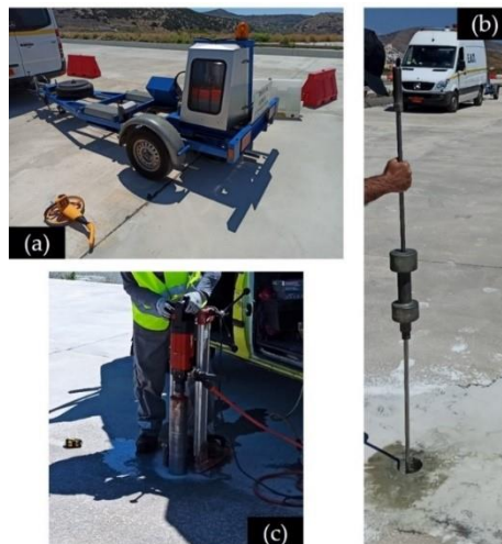
Εικόνα 10.2 Πειραματικές δοκιμές: (α) FWD, (β) DCP και (γ) πυρηνοληψίες
