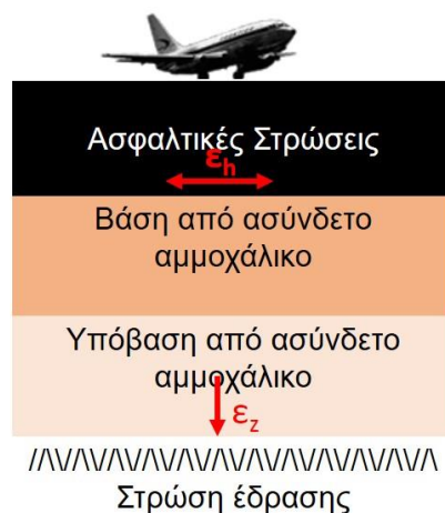
Εικόνα 2.5 Κρίσιμες θέσεις αστοχίας εύκαμπτου οδοστρώματος
