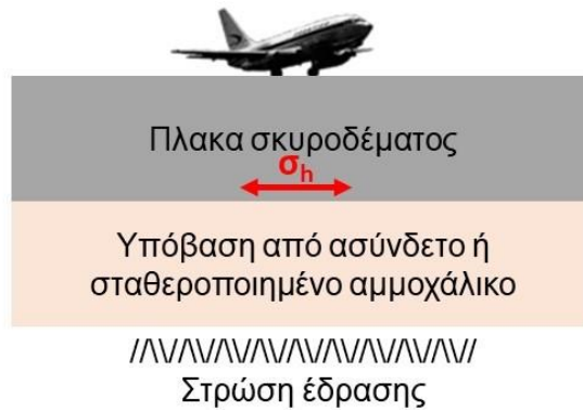
Εικόνα 3.9 Κρίσιμη θέση αστοχίας δύσκαμπτου οδοστρώματος
