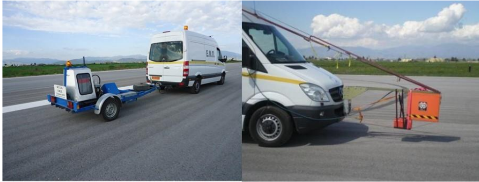
Εικόνα 6.2 Μετρήσεις FWD και GPR στο διάδρομο Π/Α αεροσκαφών
