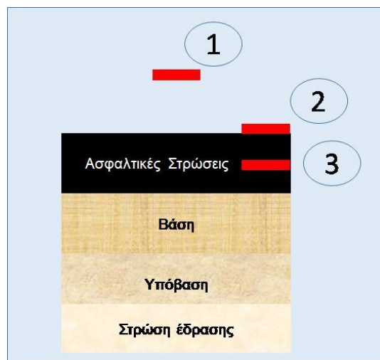
Εικόνα 2.16 Μέτρηση θερμοκρασίας: (1) αέρα, (2) επιφάνειας οδοστρώματος, (3) μέσο ασφαλτικών στρώσεων
