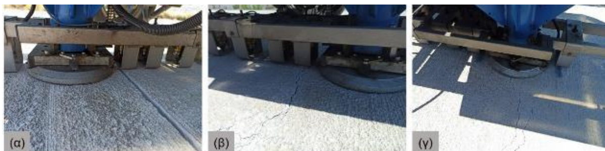
Εικόνα 10.6 (α) Μετρήσεις LTE σε αρμούς, (β) Μετρήσεις LTE σε ρωγμές και (γ) Μετρήσεις απευθείας σε ρωγμή
