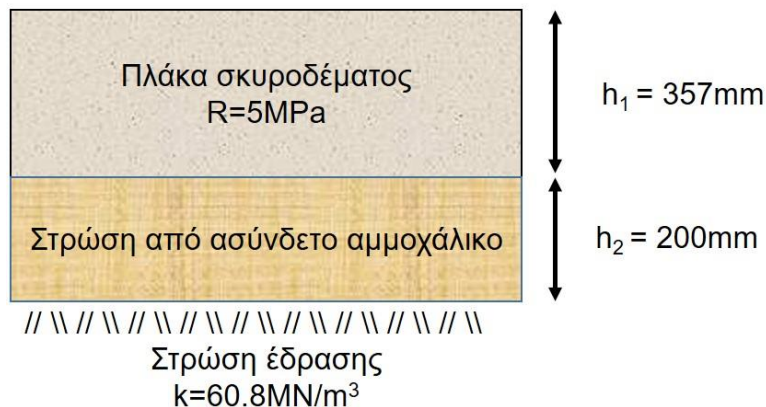
Εικόνα 9.51 Διατομή δύσκαμπτου οδοστρώματος (Διατομή Α)
