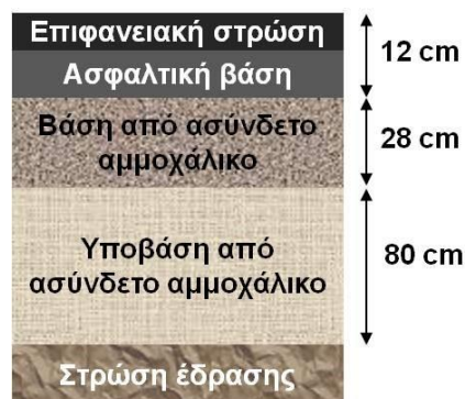
Εικόνα 7.2 Τυπική διατομή οδοστρώματος διαδρόμου Π/Α
