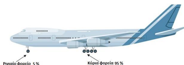
Εικόνα 2.3 Κατανομή βάρους αεροσκάφους στα φορεία
