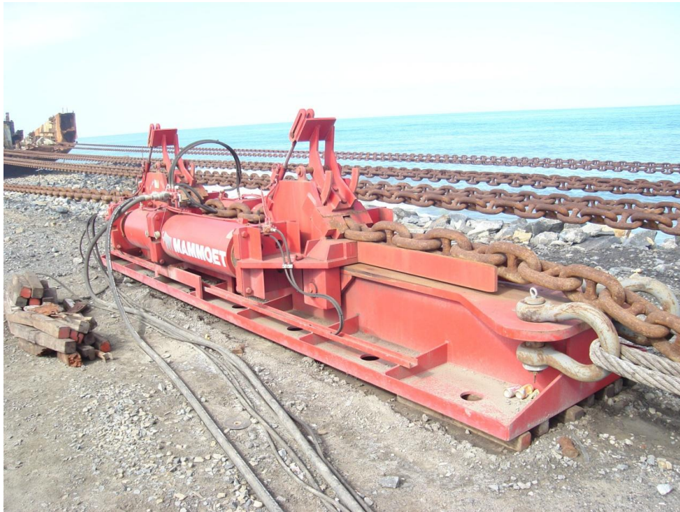
Σχήμα 4.31: Υδραυλικό σύστημα που τραβάει αλυσίδες της εταιρίας Mammoet (41).
