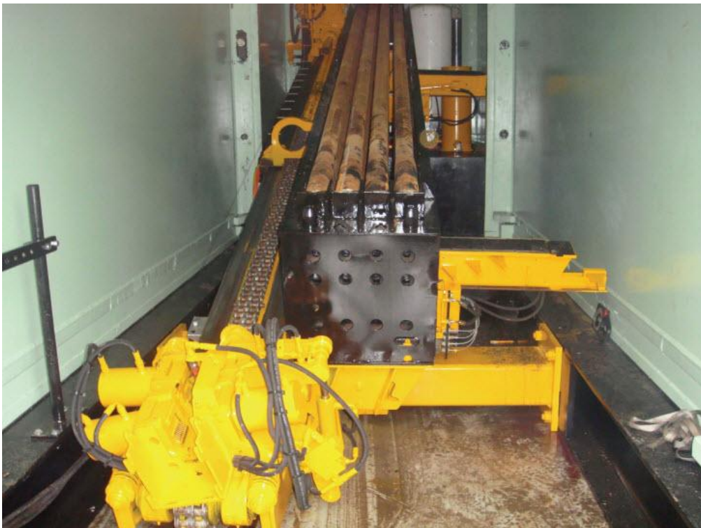
Σχήμα 5.15: Το μηχάνημα της εταιρίας που χρησιμοποιήθηκε για να περαστούν οι αλυσίδες κάτω από το ναύαγιο (42).
