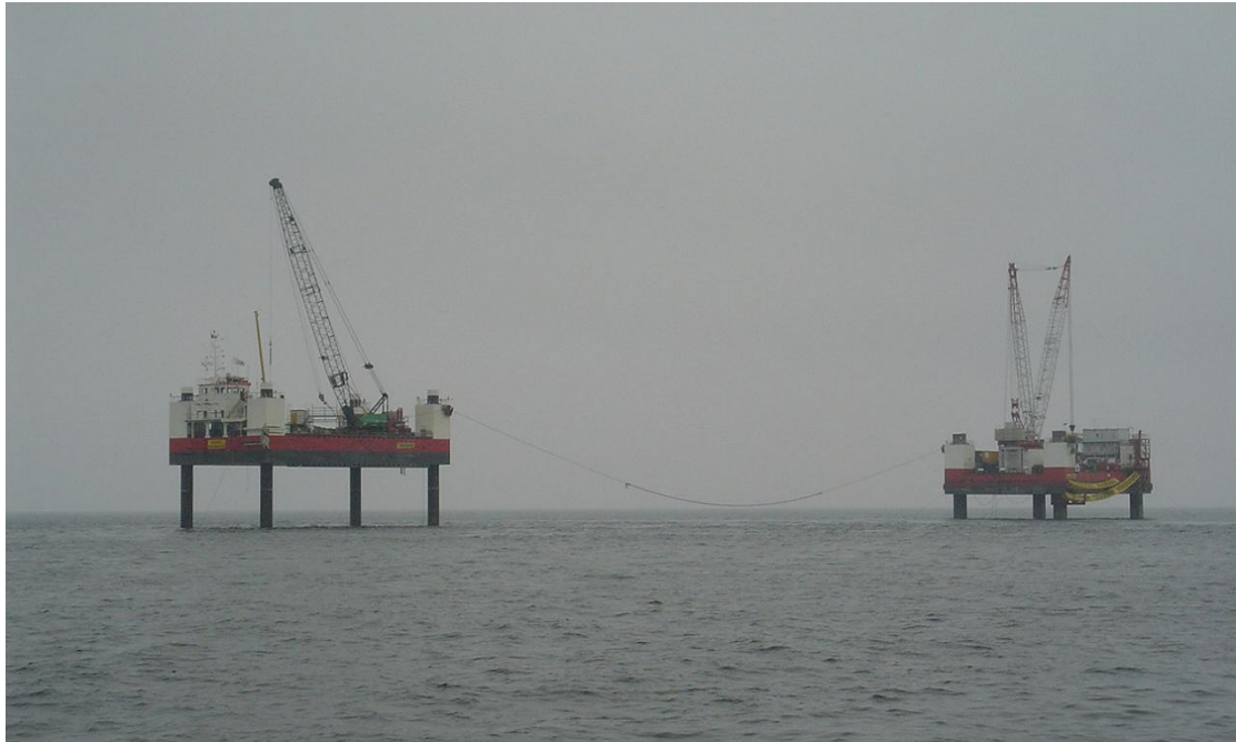
Σχήμα 5.21: Οι δύο εξέδρες Buzzard και Vacant στο τέλος της διαδικασίας κοπής ενός κομματιού του Tricolor (48).
