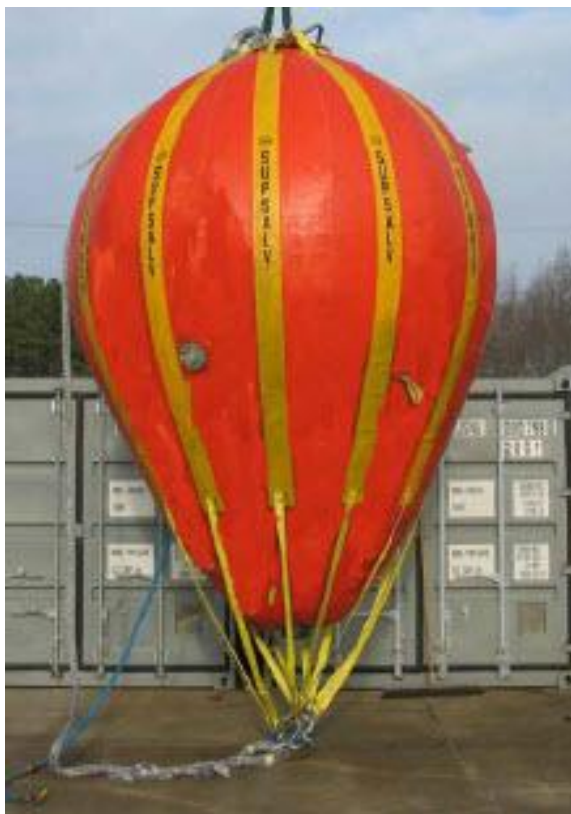
Σχήμα 4.17: Μπαλόνι το οποίο χρησιμοποιείται στις ναυαγαιρέσεις (76).
