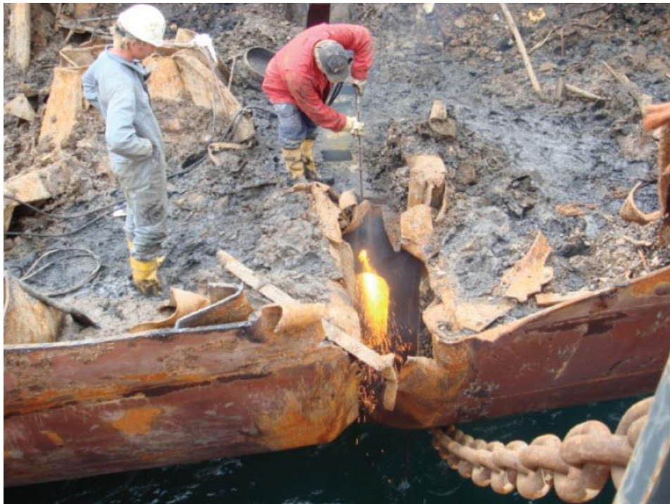
Σχήμα 5.19: Διάλυση με ηλεκτρόδιο (42).
