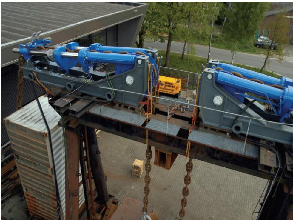
Σχήμα 4.32: Ειδικό σύστημα ανέλκυσης με αλυσίδες που χρησιμοποιήθηκε για πρώτη φορά στην ανέλκυση του πυρμαϊού κομματιού του Msc Napoli (42).
