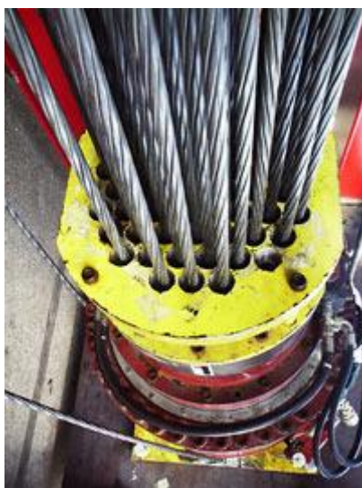
Σχήμα 5.4: Τα συρματόσχοινα περασμένα στο ειδικό σύστημα ανύψωσης της Mammoet (41).
