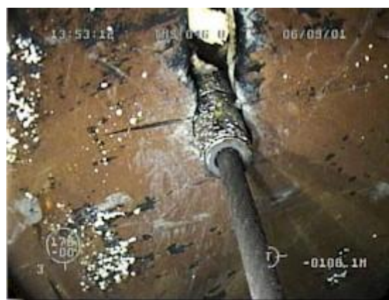
Σχήμα 5.3: Το συρματόσχοινο του συστήματος κοπής κατά την διάρκεια δοκιμών πριν την χρησιμοποίηση του στο ναυάγιο του Kursk (44).
