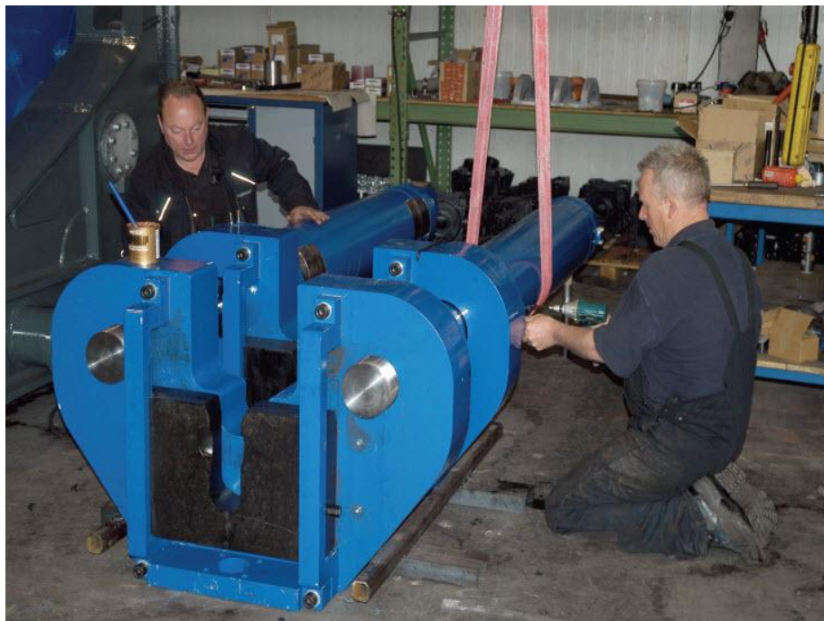
Σχήμα 5.12: Το ειδικό σύστημα ανέλκυσης κατά την κατασκευή του (42).
