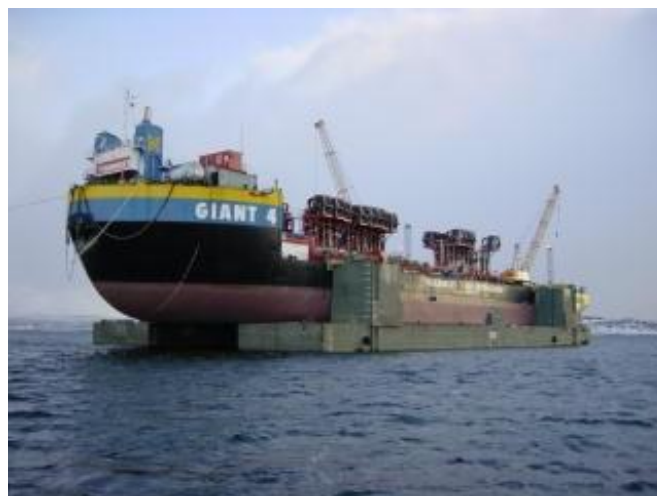
Σχήμα 5.8: Φαίνεται πως μειώθηκε το βύθισμα της πλωτής εξέδρας ώστε να μπορέσει να μπει σε πλωτή δεξαμενή (44).
