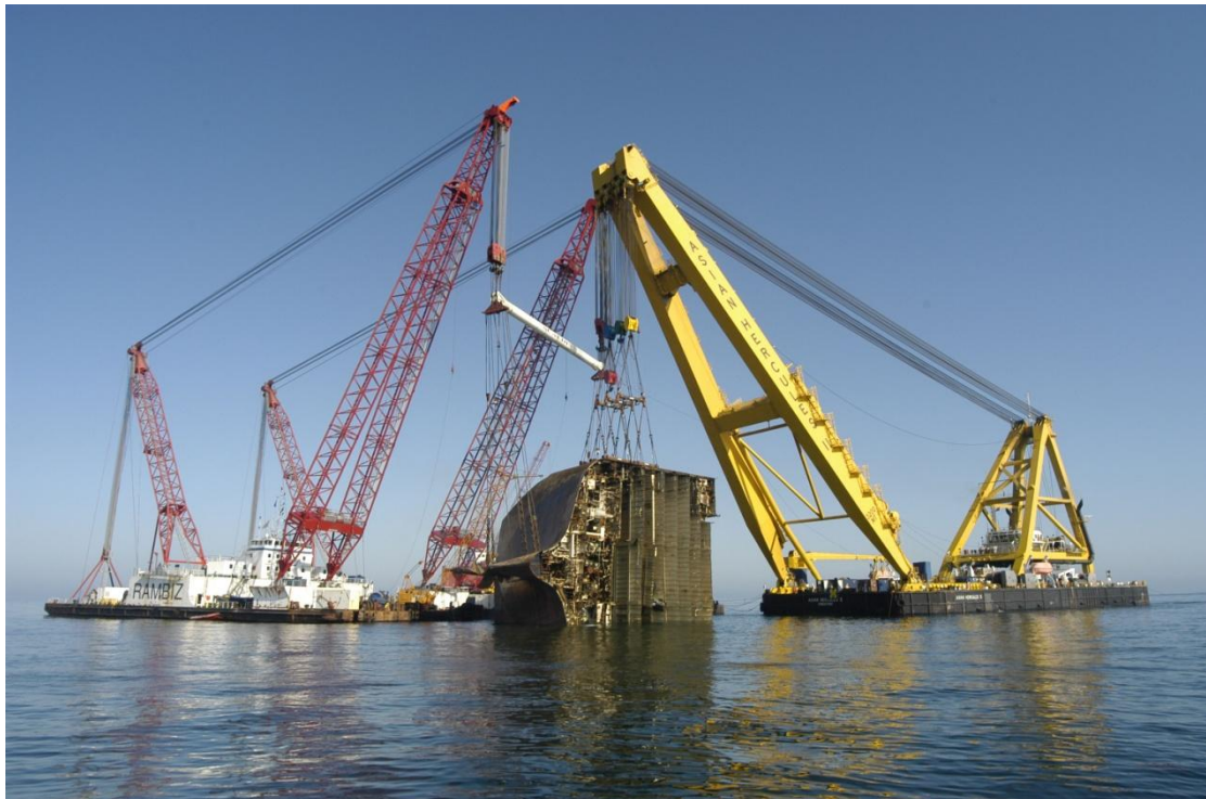
Σχήμα 5.22: Η στιγμή που το πρώτο και πιο βαρύ κομμάτι του Tricolor βγαίνει από την επιφάνεια της θάλασσας (48).
