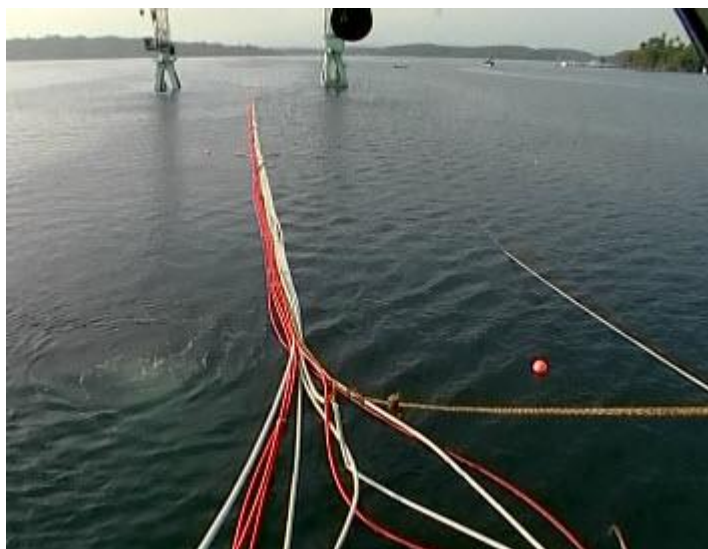
Σχήμα 5.30: Οι σωλήνες που ξεκινάν από το Perdana Sakti και καταλήγουν στην δεξαμενή. Το χρώμα υποδηλώνει σε πια μεριά ανήκουν (52).
