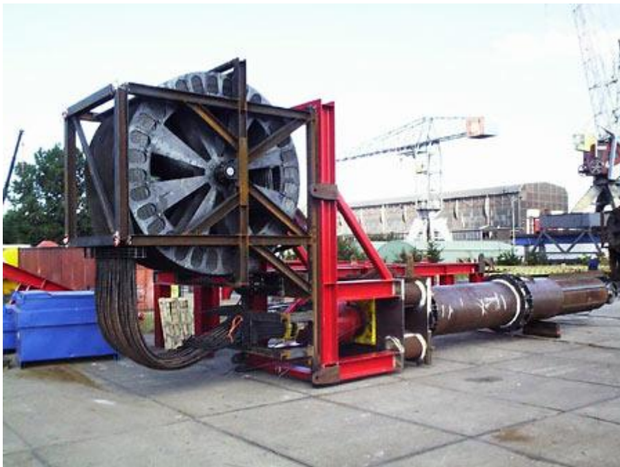
Σχήμα 5.6: Το σύστημα ανύψωσης και το σύστημα απορρόφησης κυματισμών πριν την εγκατάστασή τους στην πλωτή εξέδρα (44).
