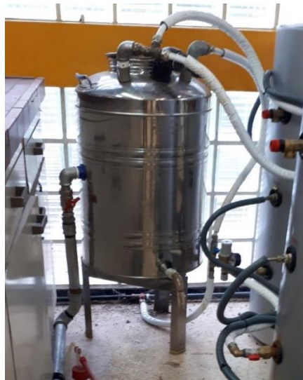
Εικόνα 22: Εναλλάκτης θερμότητας για την συμπύκνωση της αιθανόλης.
