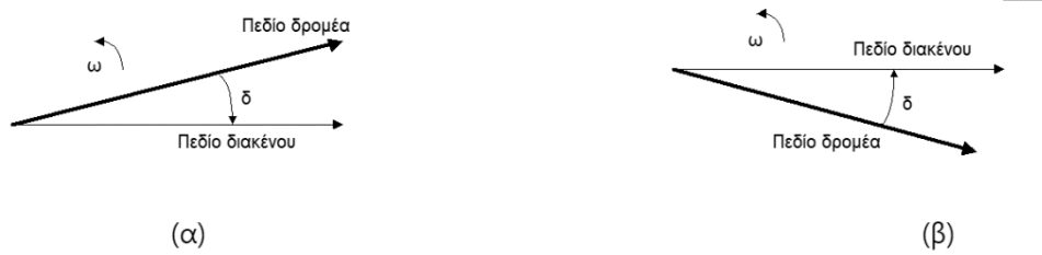
Σχ.21 Η διάταξη των πεδίων δρομέα και διακένου στη σύγχρονη μηχανή και η γωνία ροπής (α) σε γεννήτρια (β) σε κινητήρα
