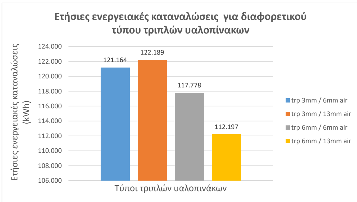
Εικόνα 9.14 - Ετήσιες ενεργειακές καταναλώσεις μοντέλου για διαφορετικού τύπου τριπλών υαλοπινάκων
