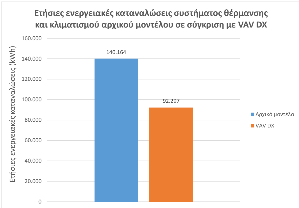
Εικόνα 9.21 - Ετήσιες ενεργειακές καταναλώσεις συστήματος θέρμανσης και κλιματισμού αρχικού μοντέλου σε σύγκριση με VAV DX
