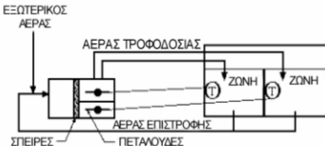
Εικόνα 5.5 - Πολυζωνικό σύστημα σταθερού όγκου [27]
