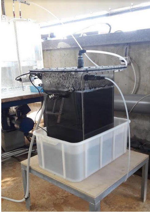
Εικόνα 4.2: Αντιδραστήρας με λύματα
