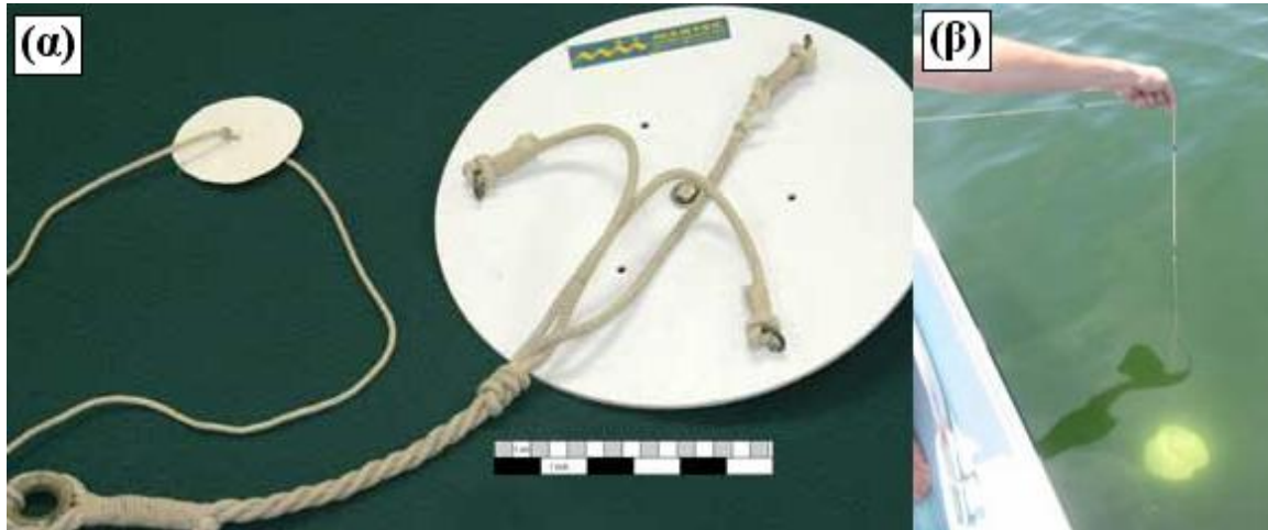
Εικόνα 1:(α) Δίσκος του Secchi (β) Χρήση του Δίσκου Secchi για μέτρηση διαφάνειας στο πεδίο
