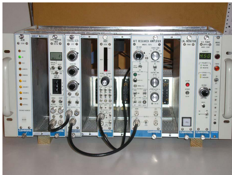
Εικόνα 2.9: Ηλεκτρονικά υποστήριξης του ανιχνευτή XtRa (Πηγή: Χάλαρης Γεώργιος, Ποσοτικός προσδιορισμός ιχνοστοιχείων και βαρέων μετάλλων σε παράκτια ιζήματα με νετρονική ενεργοποίηση (NAA), Διπλωματική Εργασία, ΔΠΜΣ ΕΜΠ, Ιανουάριος, 2020)
