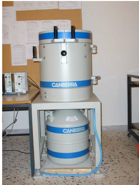
Εικόνα 2.8: Ο ανιχνευτής XtRa με τη θωράκισή του και το δοχείο αζώτου (Πηγή: Χάλαρης Γεώργιος, Ποσοτικός προσδιορισμός ιχνοστοιχείων και βαρέων μετάλλων σε παράκτια ιζήματα με νετρονική ενεργοποίηση (NAA), Διπλωματική Εργασία, ΔΠΜΣ ΕΜΠ, Ιανουάριος, 2020)
