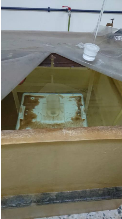
Εικόνα 2.6: Εσωτερικό διάταξης νετρονικής ενεργοποίησης (Πηγή: Προσωπικό αρχείο)
