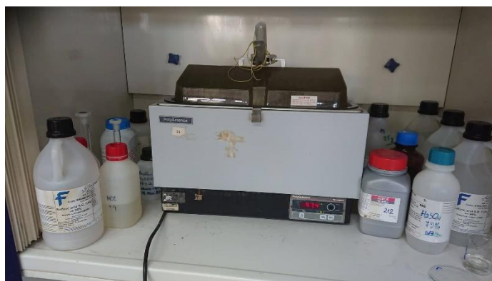
Εικόνα 4.3: Το υδατόλουτρο εντός του οποίου τοποθετήθηκαν οι δειματοφορείς (Πηγή: Προσωπικό αρχείο)
