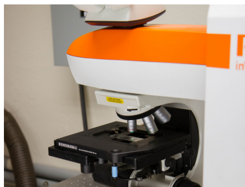
Σχήμα 6.2: Το μικροσκόπιο που είναι ενσωματωμένο στο σύστημα του φασματογράφου InVia Reflex [38].
