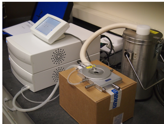
Σχήμα 6.6: Ο πλήρης πειραματικός εξοπλισμός που πλαισιώνει την κυψελίδα. Η χρήση ενός δοχείου Dewar για την αποθήκευση του υγρού αζώτου, δύο μονάδων ως σύστημα ψύξης/θέρμανσης και μίας οθόνης αφής κρίνονται απαραίτητες για την ορθή διεξαγωγή της διαδικασίας [41].
