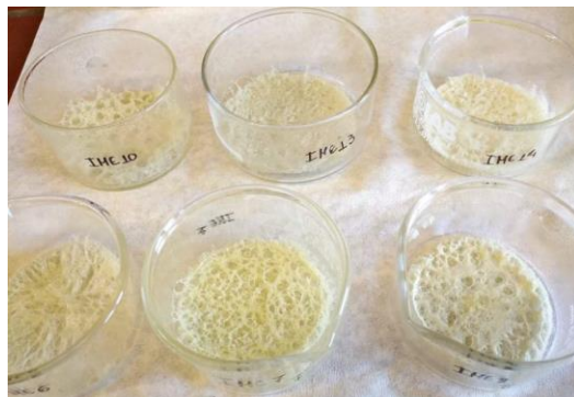
Εικόνα 25. Λυοφιλοποιημένα νανοσωματίδια αλγινικού – χιτοζάνης με εγκλωβισμένη ναρινγίνη από πειράματα του πειραματικού σχεδιασμού
