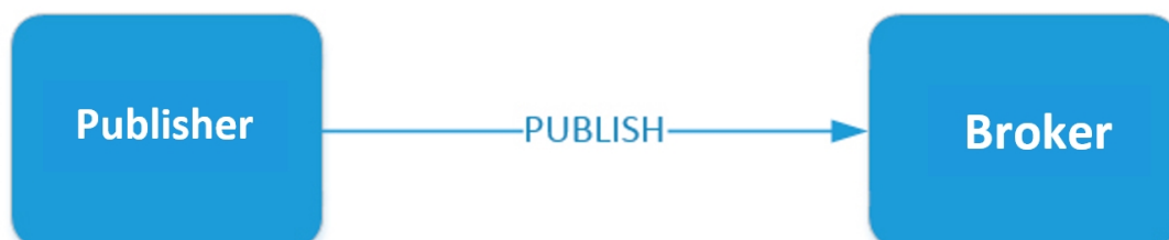
Σχήμα 3.4: MQTT με QoS = 0
