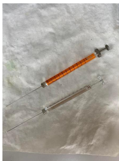
Εικόνα 20 : Σύριγγες εισαγωγής δείγματος στη βαλβίδα εισαγωγής του HPLC
