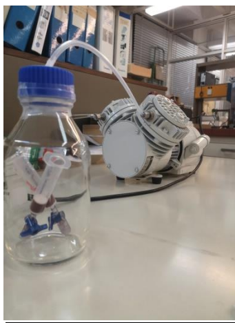
Εικόνα 18 : SPE στήλες και αντλία κενού
