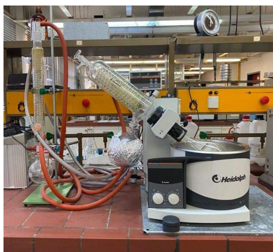
Εικόνα 16 : Διάταξη Rotary Evaporator που χρησιμοποιήθηκε
