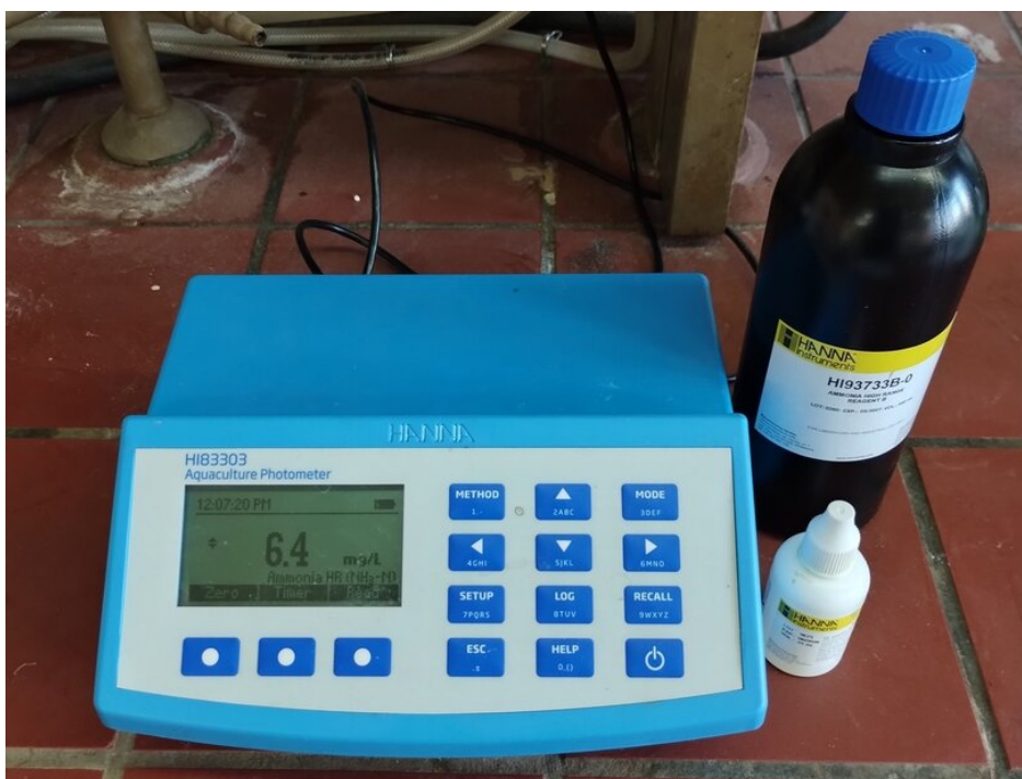
Σχήμα 2.15: Φωτόμετρο Hanna Aquaculture Photometer HI83303 και αντιδραστήρια (HI-93733-01 Ammonia HR kit) για τον προσδιορισμό του αμμωνιακού αζώτου.
