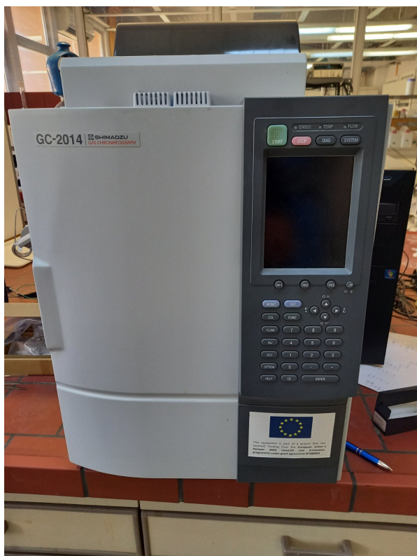
Σχήμα 2.18: Αέριος Χρωματογράφος Shimadzu GC-2014 με ανιχνευτή TDC για τον προσδιορισμό της σύστασης του βιοαερίου
