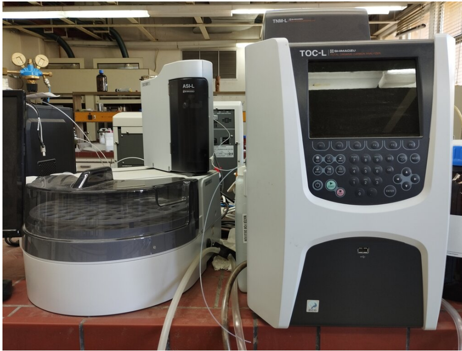
Σχήμα 2.10: Autosampler SHIMADZU ASI-L (αριστερά), όργανο μέτρησης ολικού οργανικού άνθρακα SHIMADZU Total Organic Carbon Analyzer (TOC-L) (δεξιά) και όργανο μέτρησης ολικού αζώτου SHIMADZU Total Nitrogen Measuring Unit (TNM-L) (δεξιά πάνω)
