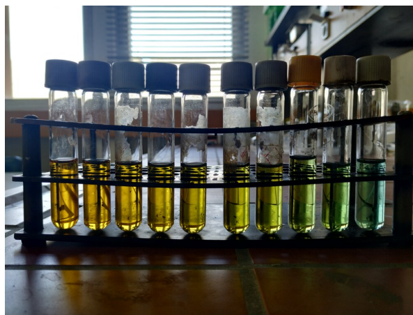
Σχήμα 2.5: Φιαλίδια προς φωτομέτρηση μετά την ολοκλήρωση της οξείδωσης του οργανικού φορτίου. Τα δείγματα αποτελούν σημεία καμπύλης βαθμονόμησης, εξ ου και η σταδιακή μεταβολή του χρώματος από πορτοκαλί (μηδενικό COD) προς μπλε (COD = 1 g/L).
