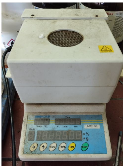
Σχήμα 2.14: Υγρασιόμετρο Adam AMB50, για τον προσδιορισμό της υγρασίας σε στερεά.
