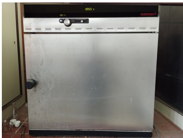
Σχήμα 2.8: Φούρνος θερμοκρασίας 105^{\circ}\text{C} για την απομάκρυνση της υγρασίας από τα στερεά.
