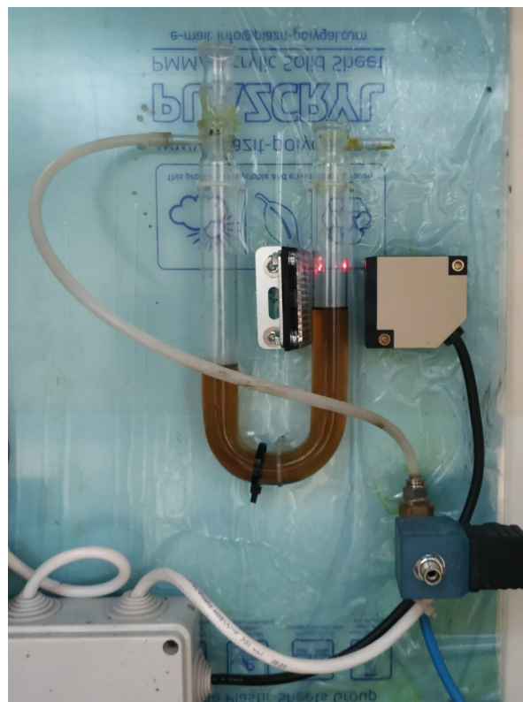
Σχήμα 2.19: Διάταξη μέτρησης παραγόμενης ποσότητας βιοαερίου με τη μέθοδο της θετικής εκτόπισης υγρού
