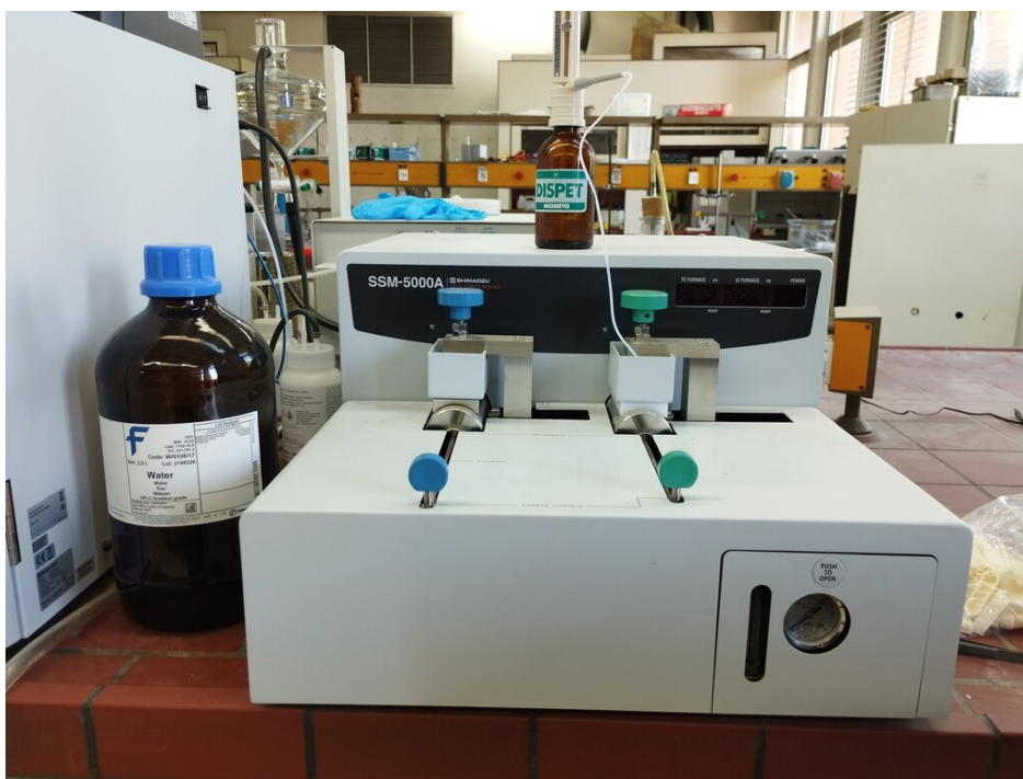
Σχήμα 2.11: Μονάδα στερεών δειγμάτων SHIMADZU SSM-5000A Solid Sample Module, στην οποία τοποθετούνται οι δειγματοφορείς με τα δείγματα προς ανάλυση του ολικού και του ανόργανου άνθρακα.
