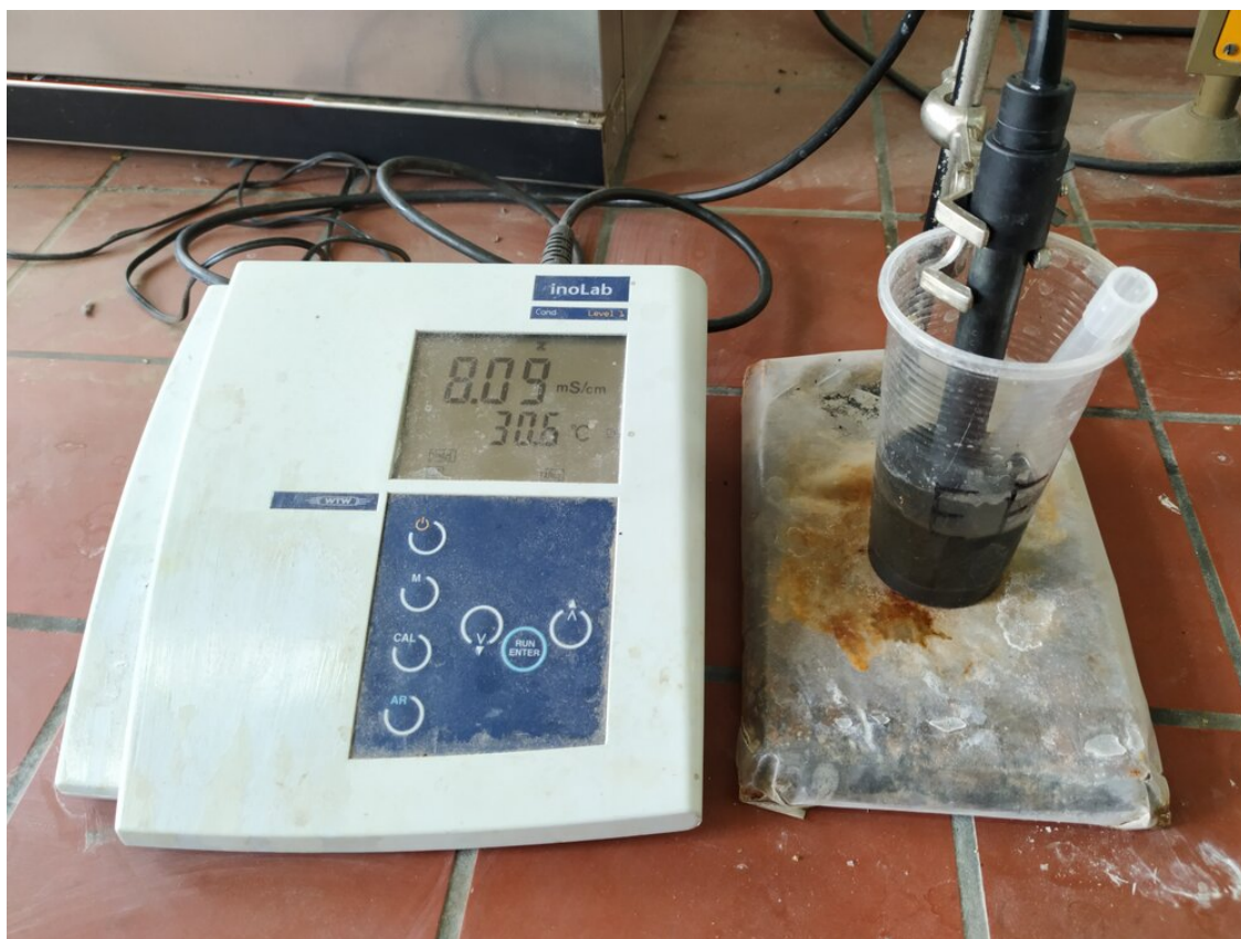
Σχήμα 2.3: Μέτρηση αγωγιμότητας με το ηλεκτρονικό αγωγιμόμετρο πάγκου "inoLab Cond Level 1" και ηλεκτρόδιο "WTW TetraCon 325".
