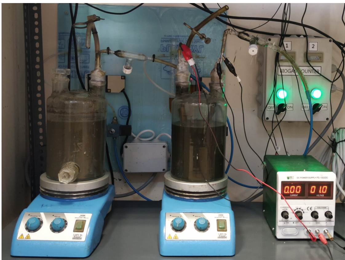
Σχήμα 2.1: Πειραματικές διατάξεις αναερόβιας χώνευσης (αριστερά) και ηλεκτροζύμωσης (δεξιά).
