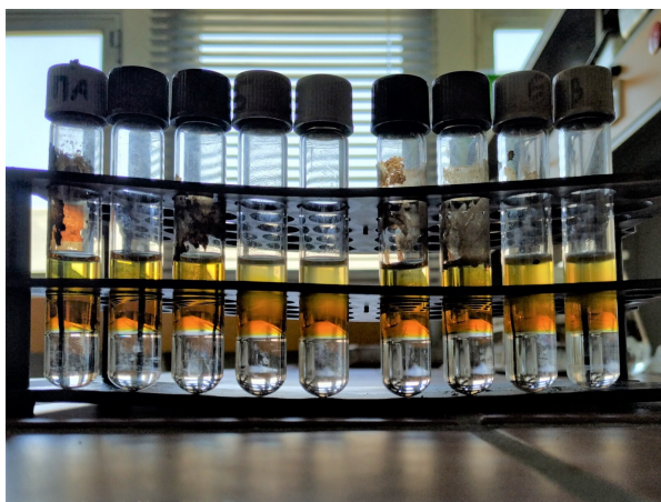
Σχήμα 2.4: Φιαλίδια με δείγματα προς προσδιορισμό Χημικά Απαιτούμενου Οξυγόνου. Διακρίνονται από κάτω προς τα πάνω οι φάσεις του καταλύτη, του οξειδωτικού και του δείγματος.
