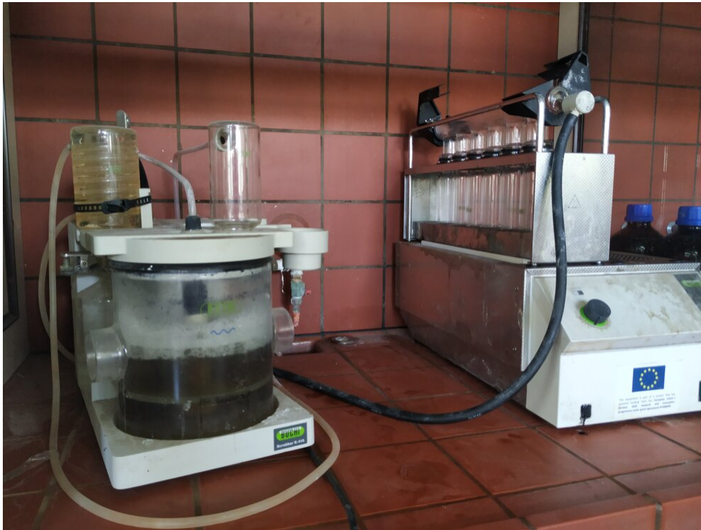
Σχήμα 2.12: Συσκευή χώνευσης δειγμάτων για τον προσδιορισμό του ολικού αζώτου κατά Kjeldahl (TKN) (δεξιά) και scrubber για την απομάκρυνση των όξινων αερίων της χώνευσης (αριστερά).
