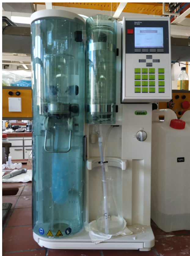
Σχήμα 2.13: Συσκευή απόσταξης KjelFlex K-360 για την απελευθέρωση αμμωνίας και την προετοιμασία του προς τιτλοδότηση διαλύματος.
