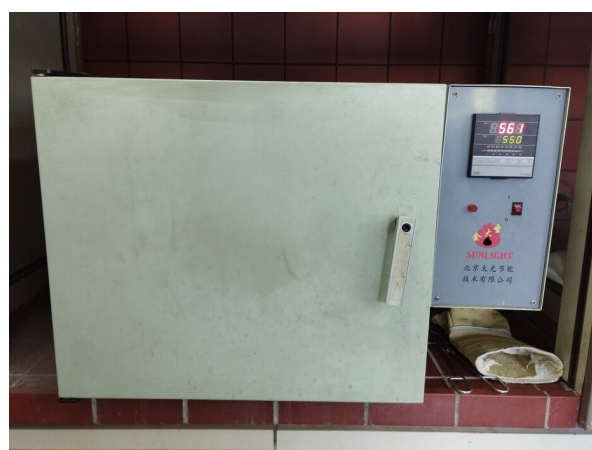
Σχήμα 2.9: Φούρνος θερμοκρασίας 550^{\circ}\text{C} για την απομάκρυνση των πτητικών στερεών.
