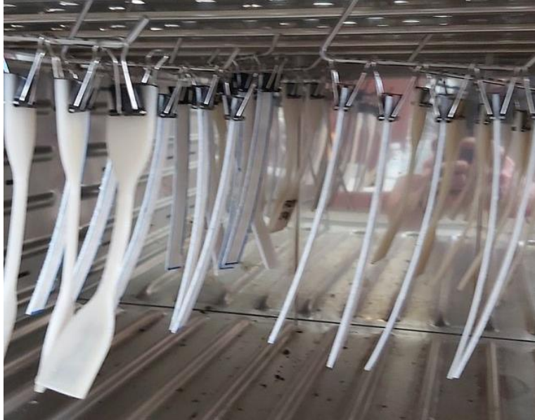
Εικόνα 76: Δοκίμια FR29 πριν την γήρανση (0d)
