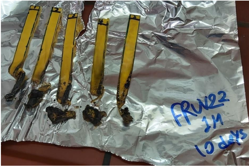
Εικόνα 63: Δείγματα καύσης FRUV22IM μετά από 10d γήρανσης
