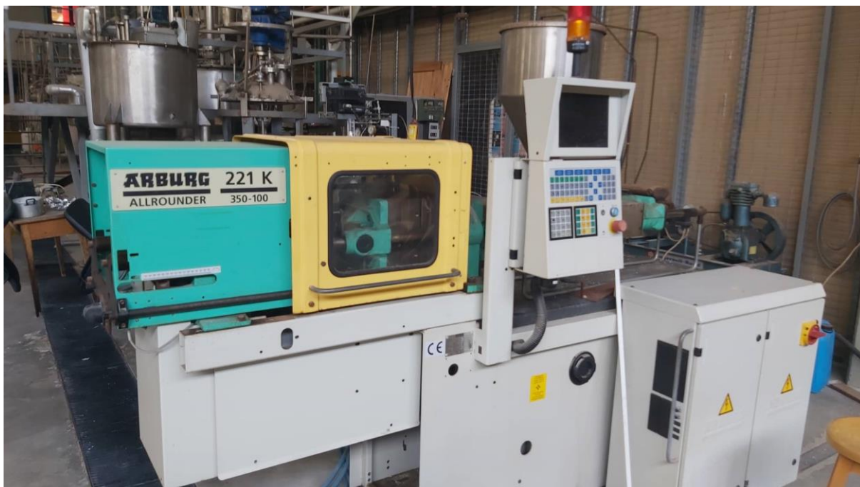
Εικόνα 24: Μηχάνημα Έγχυσης που διατίθεται στο εργαστήριο
