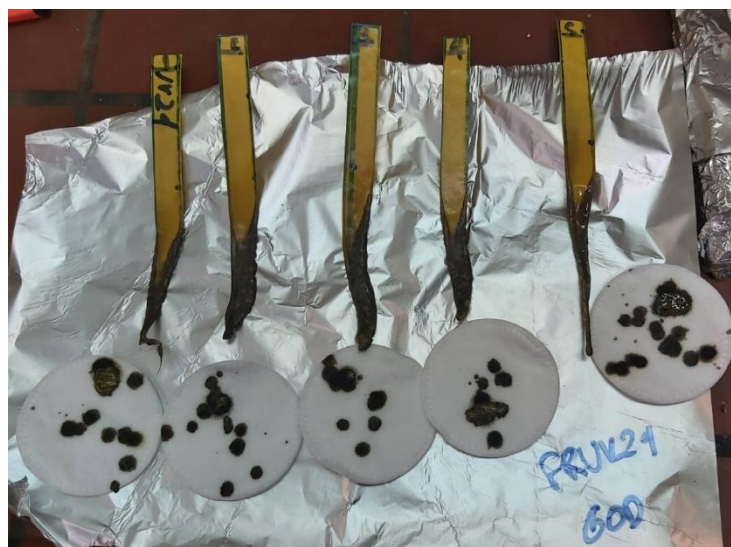
Εικόνα 74: Δείγματα καύσης FRUV29 μετά από 60d γήρανσης
