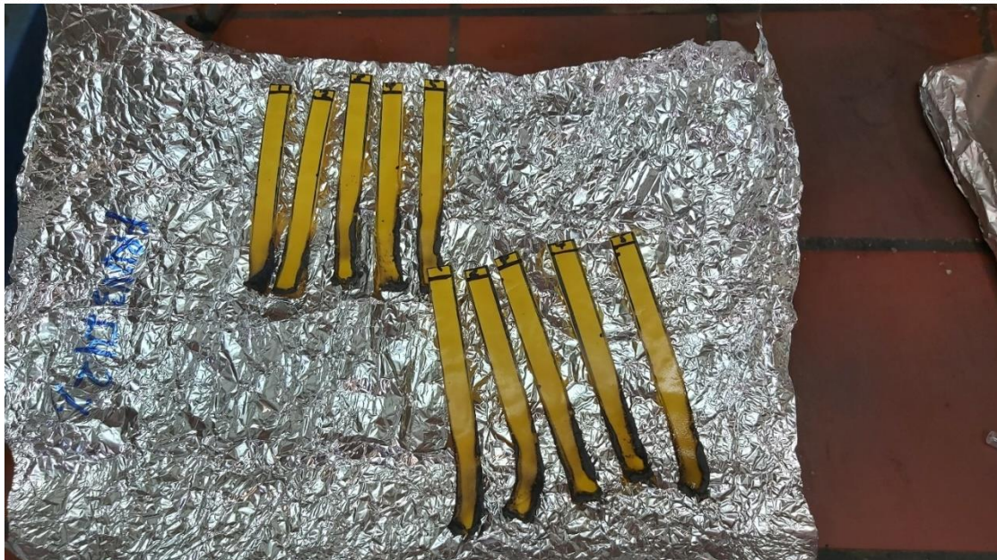
Εικόνα 43: Δείγματα FR3 + 2% Impact Modifier μετά την καύση
