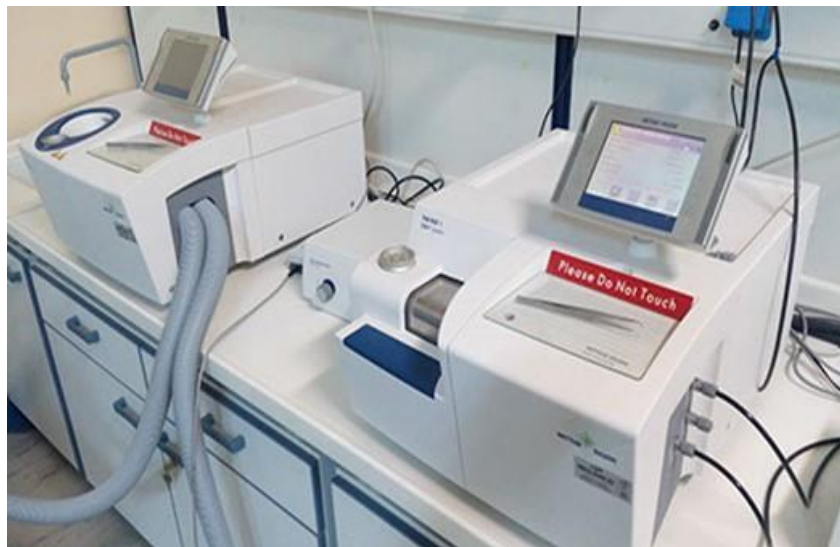
Εικόνα 31: Μηχάνημα DSC (στα αριστερά) και TGA (στα δεξιά) που διατίθενται στο εργαστήριο
