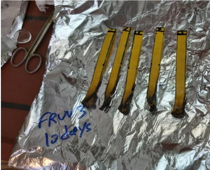
Εικόνα 48: Δείγματα καύσης FRUV3 μετά από 10d γήρανσης
