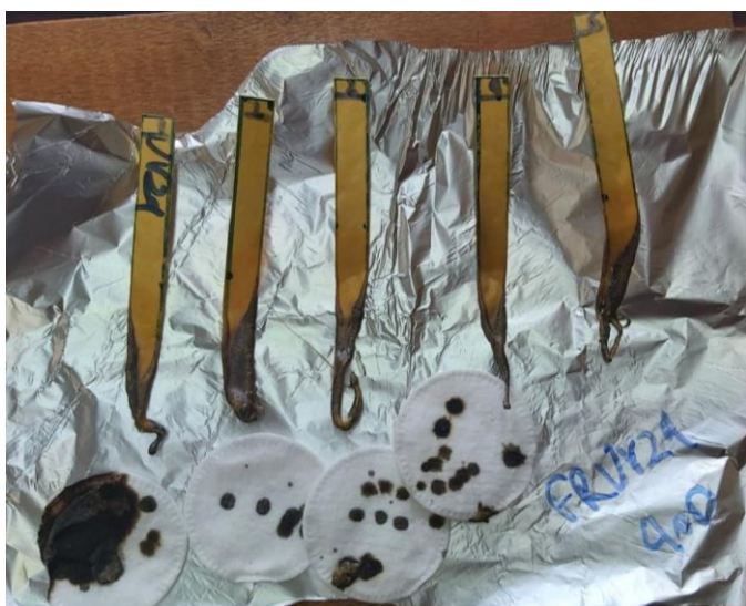
Εικόνα 75: Δείγματα καύσης FRUV29 μετά από 40d γήρανσης
