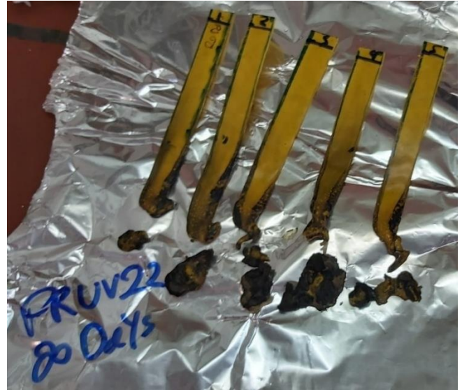
Εικόνα 59: Δείγματα καύσης FRUV22 μετά από 20d γήρανσης
