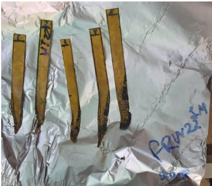
Εικόνα 65: Δείγματα καύσης FRUV22IM μετά από 40d γήρανσης
