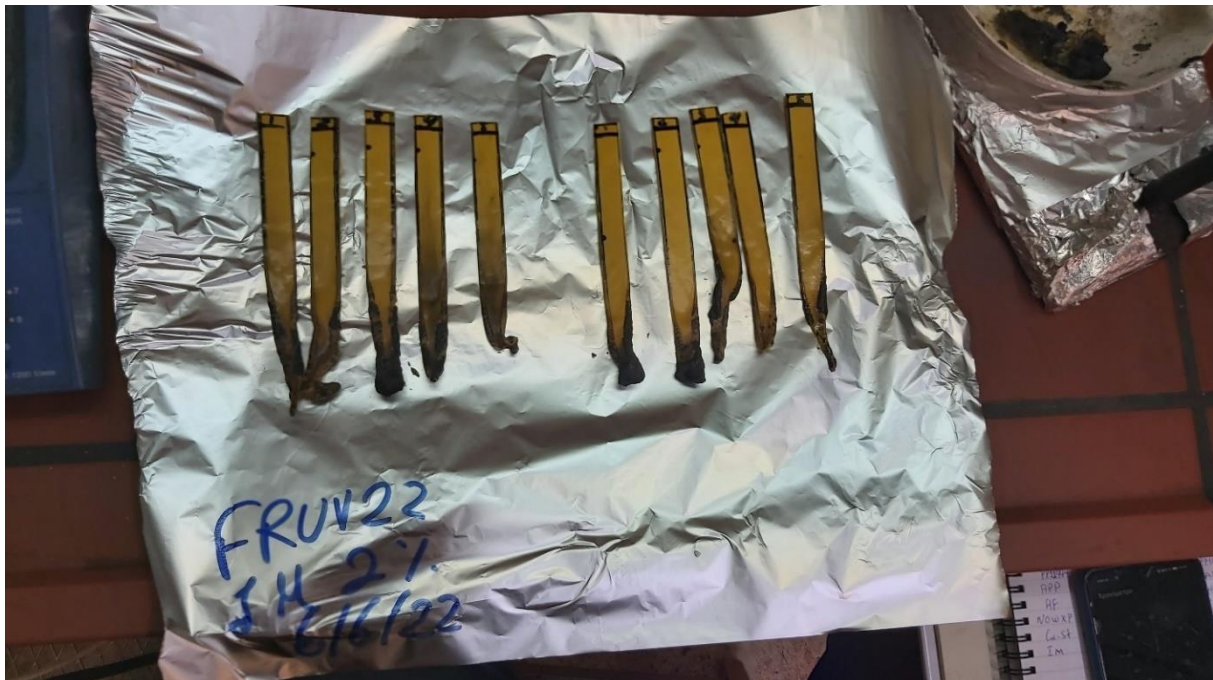
Εικόνα 44: Δείγματα FR22 + 2% Impact Modifier μετά την καύση
