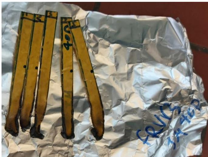
Εικόνα 53: Δείγματα καύσης FRUV3IM μετά από 40d γήρανσης
