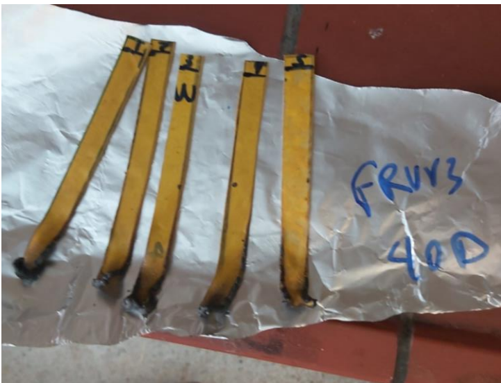
Εικόνα 50: Δείγματα καύσης FRUV3 μετά από 40d γήρανσης
