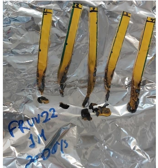
Εικόνα 62: Δείγματα καύσης FRUV22IM μετά από 20d γήρανσης
