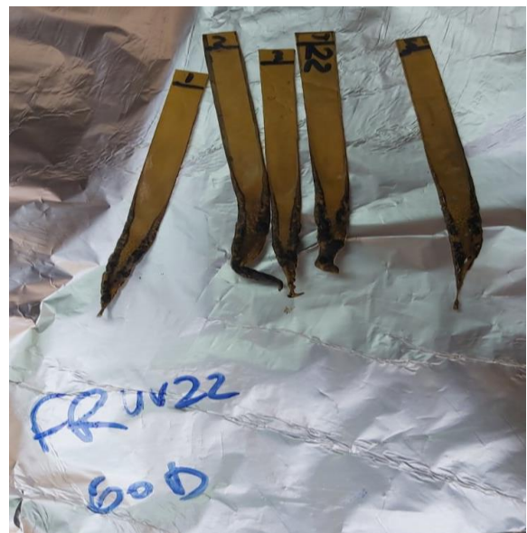
Εικόνα 61: Δείγματα καύσης FRUV22 μετά από 60d γήρανσης
