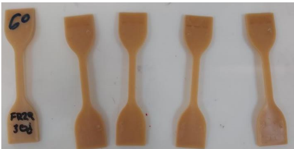
Εικόνα 78: Δοκίμια FR29 στις 60 μέρες γήρασης
