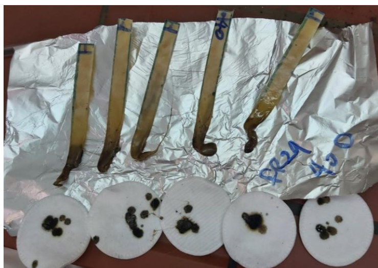
Εικόνα 71: Δείγματα καύσης FR29 μετά από 40d γήρασης
