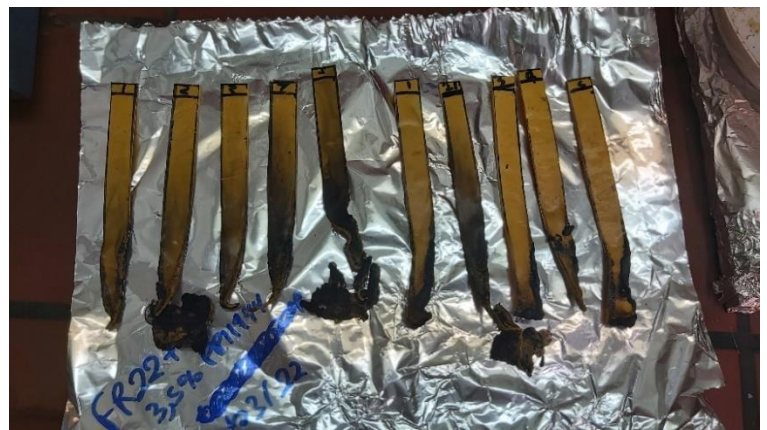
Εικόνα 38: Δείγματα FRUV22 μετά την καύση
