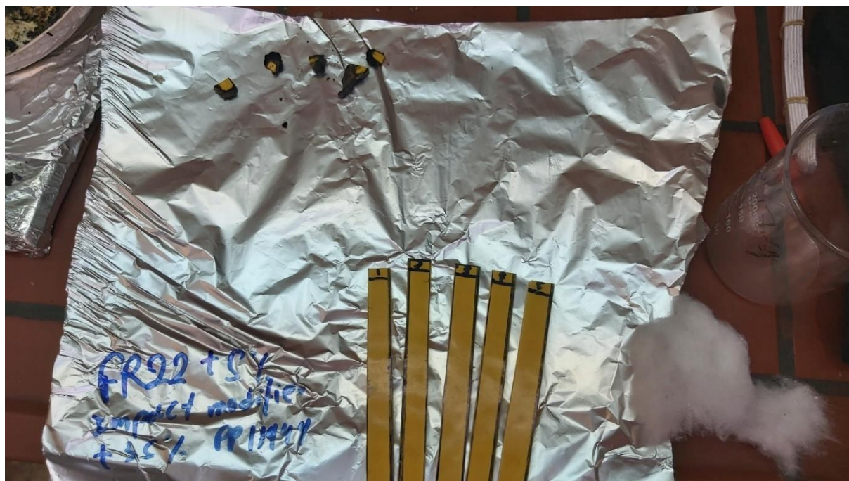
Εικόνα 45: Δείγματα FR22 + 5% Impact Modifier μετά την καύση
