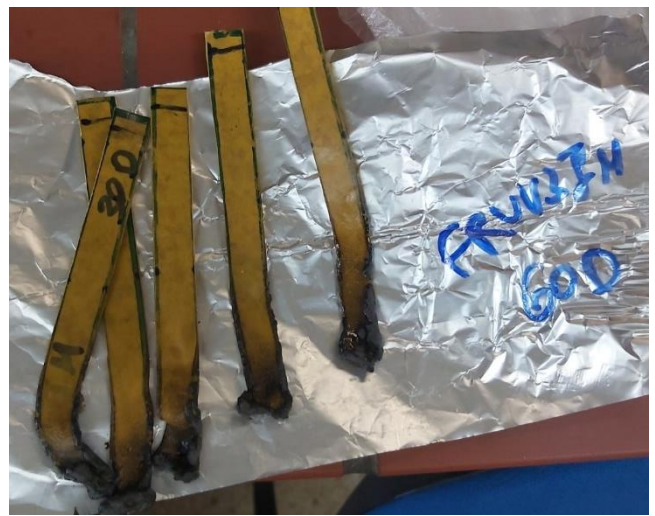
Εικόνα 54: Δείγματα καύσης FRUV3IM μετά από 60d γήρανσης
