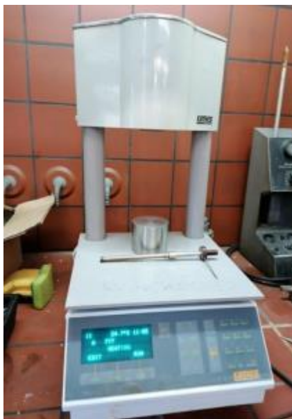
Εικόνα 26: Μηχάνημα MFR που διατίθεται στο εργαστήριο
