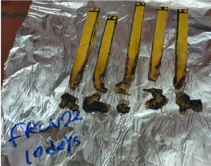
Εικόνα 58: Δείγματα καύσης FRUV22 μετά από 10d γήρανσης
