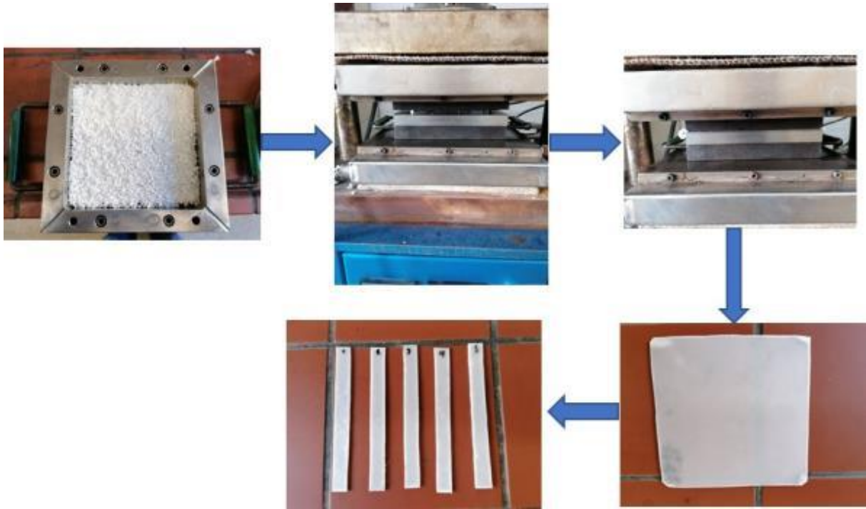
Εικόνα 22: Διαδικασία Παρασκευής δειγμάτων με θερμική συμπίεση
