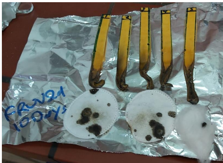
Εικόνα 73: Δείγματα καύσης FRUV29 μετά από 10d γήρανσης
