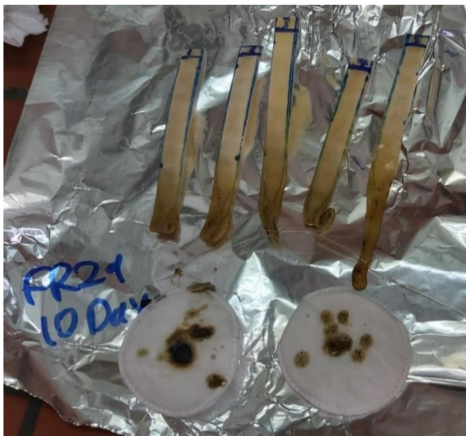
Εικόνα 68: Δείγματα καύσης FR29 μετά από 10d γήρασης
