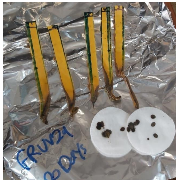
Εικόνα 72: Δείγματα καύσης FRUV29 μετά από 20d γήρανσης
