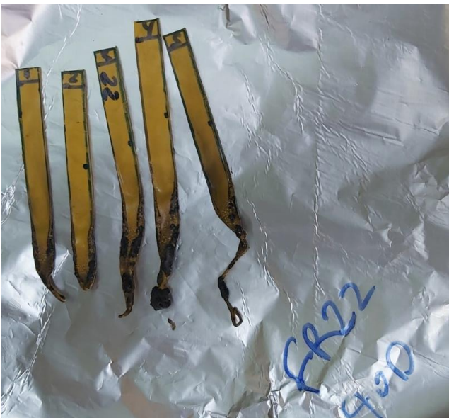
Εικόνα 60: Δείγματα καύσης FRUV22 μετά από 40d γήρανσης
