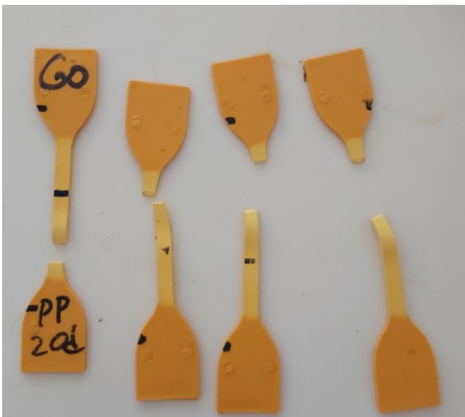
Εικόνα 56: Δοκίμια PPyellow στις 60 μέρες γήρανσης
