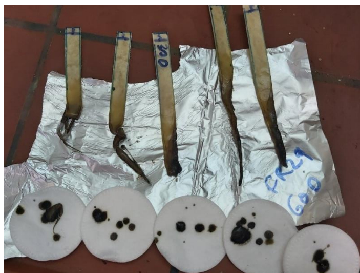
Εικόνα 70: Δείγματα καύσης FR29 μετά από 60d γήρασης
