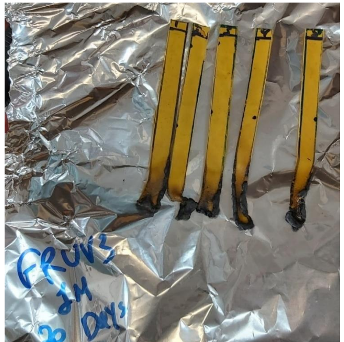
Εικόνα 52: Δείγματα καύσης FRUV3IM μετά από 20d γήρανσης
