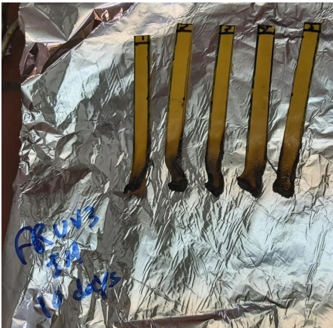
Εικόνα 51: Δείγματα καύσης FRUV3IM μετά από 10d γήρανσης
