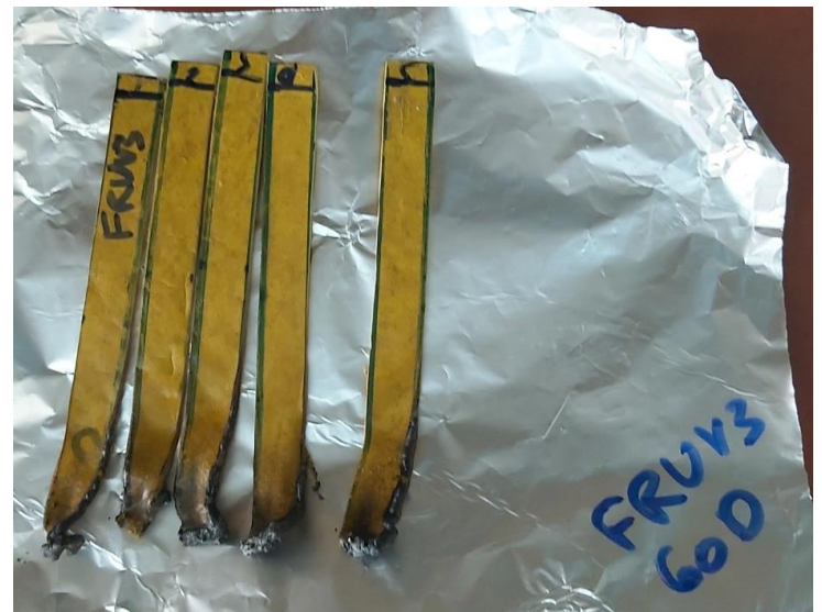
Εικόνα 49: Δείγματα καύσης FRUV3 μετά από 60d γήρανσης
