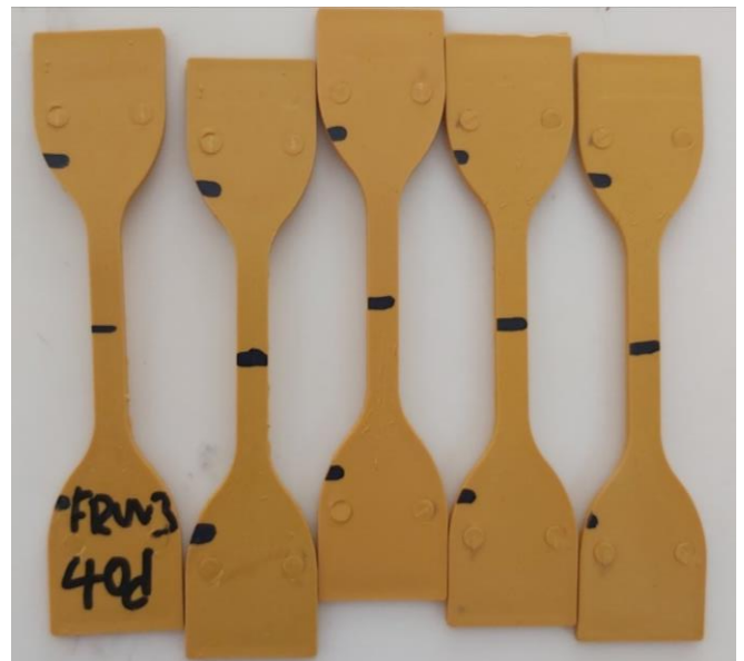
Εικόνα 55: Δοκίμια FRUV3 στις 40 μέρες γήρανσης
