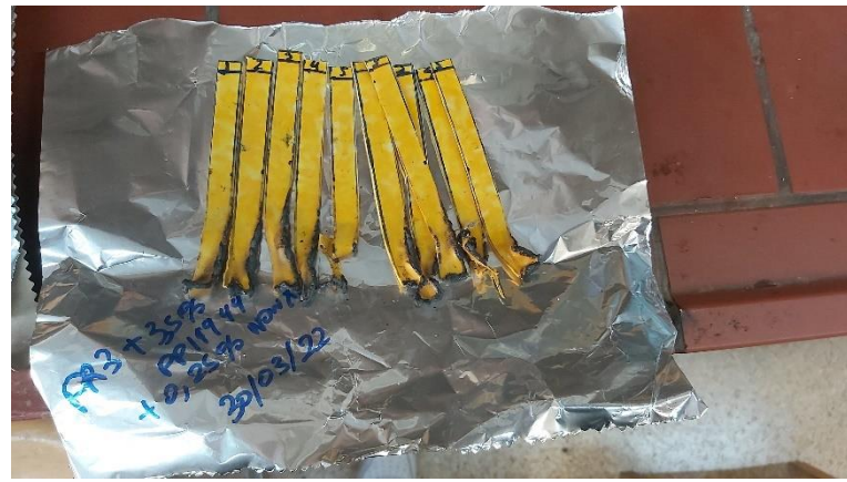
Εικόνα 36: Δείγματα FRUV3 μετά την καύση
