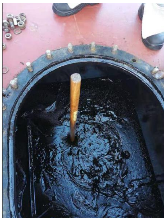
Σχέδιο 11: Δημιουργία ιζήματος σε σωληνώσεις λόγω χρήσης VLSFO
