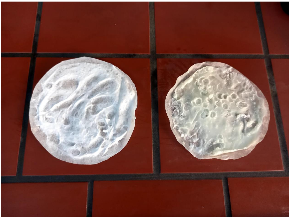
Εικόνα 15. Κρυσταλλωμένες παραφίνες που προέκυψαν μετά το πέρας της διήθησης. Αριστερά το ελαφρύ δείγμα UCO και δεξιά το βαρύ.
