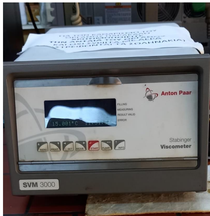
Εικόνα 16. Συσκευή Stabinger Viscometer SVM 3000.
