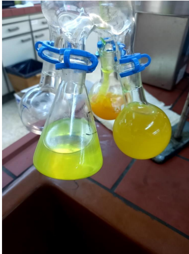
Εικόνα 11. Απόσταγματα. (στη μπροστά κωνική φιάλη έχει συλλεχθεί το πρώτο απόσταγμα με σ.ζ. 400 – 450° C σε 1 atm, στη δεξιά το απόσταγμα με σ.ζ. 450 – 500° C και το πίσω σ.ζ. < 500° C)
