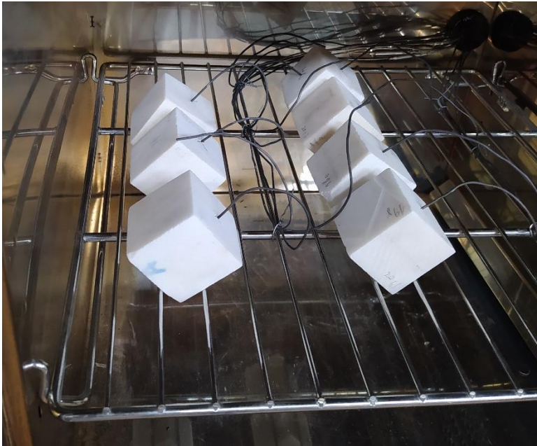
Εικόνα 9: Δοκίμια μαρμάρου κατά την προετοιμασία του θερμοκρασιακού προγράμματος πολλαπλών κύκλων
