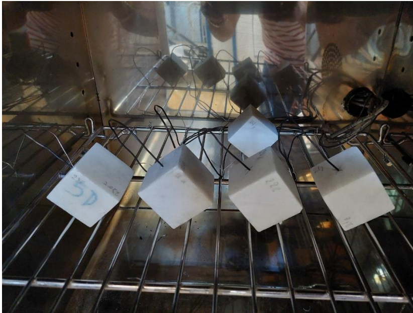
Εικόνα 8: Δοκίμια μαρμάρου κατά την προετοιμασία του θερμοκρασιακού προγράμματος 200°C
