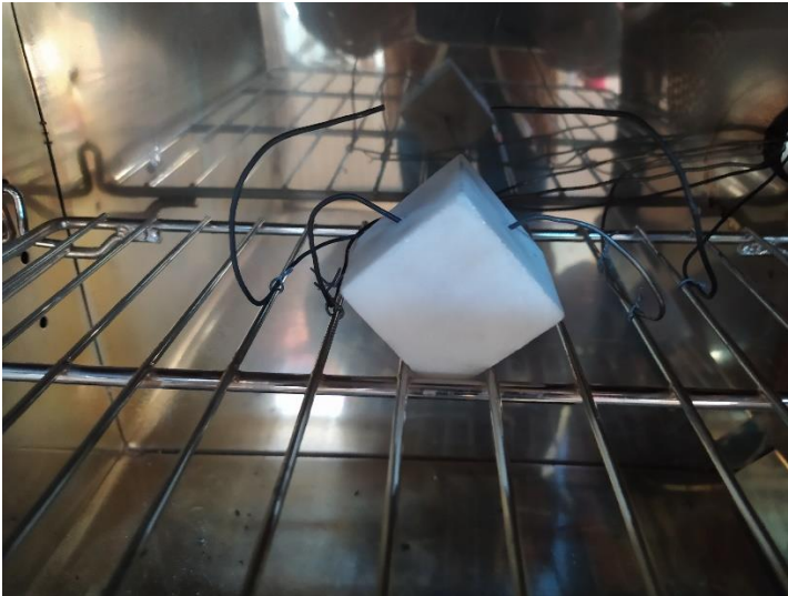
Εικόνα 7: Δοκίμιο μαρμάρου κατά την προετοιμασία του θερμοκρασιακού προγράμματος 80°C
