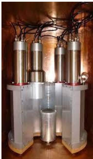
Σχήμα 2.3α Compton suppress system (όψη) [6]
