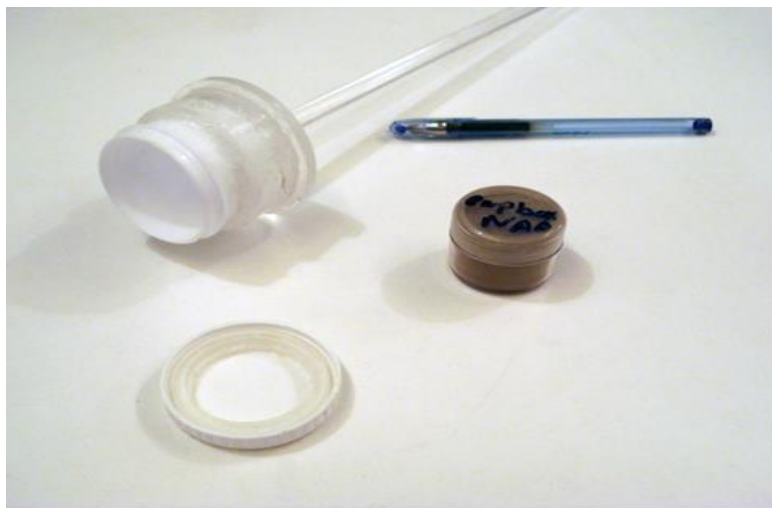
Σχήμα 4.3. Δοχείο δείγματος και δειγματοφορέας Νετρονικής ενεργοποίησης
