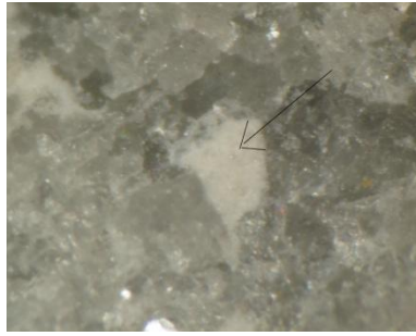
Εικόνα 6.2: Το βέλος δείχνει την εικόνα αμεταμόρφωτου ιζήματος, χαρακτηριστικό των λατομείων της Σπάρτης (φωτογραφία από οπτικό μικροσκόπιο).
