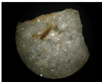
Εικόνα 6.1: Το βέλος δείχνει χαρακτηριστικό εγκλείσμα διαλυμένων οξειδίων σιδήρου (φωτογραφία από οπτικό μικροσκόπιο).
