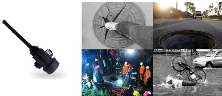
Σχήμα 4.7: Η συσκευή για την εφαρμογή παρακολούθησης μη εξουσιοδοτημένης πρόσβασης σε φρεάτια
