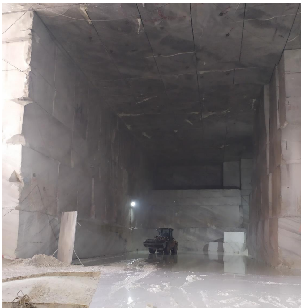
Εικόνα 2.1.1: Bench mining σε υπόγεια εκμετάλλευση μαρμάρου (ΙΚΤΙΝΟΣ ΕΛΛΑΣ Α.Ε.)
