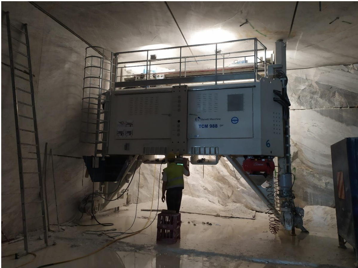
Εικόνα 1.4.2: Εξόρυξη όγκου με αλυσοπρίοιο Benetti Machine TCM 988 Plus (IKTINOS ELLAS A.E.)
