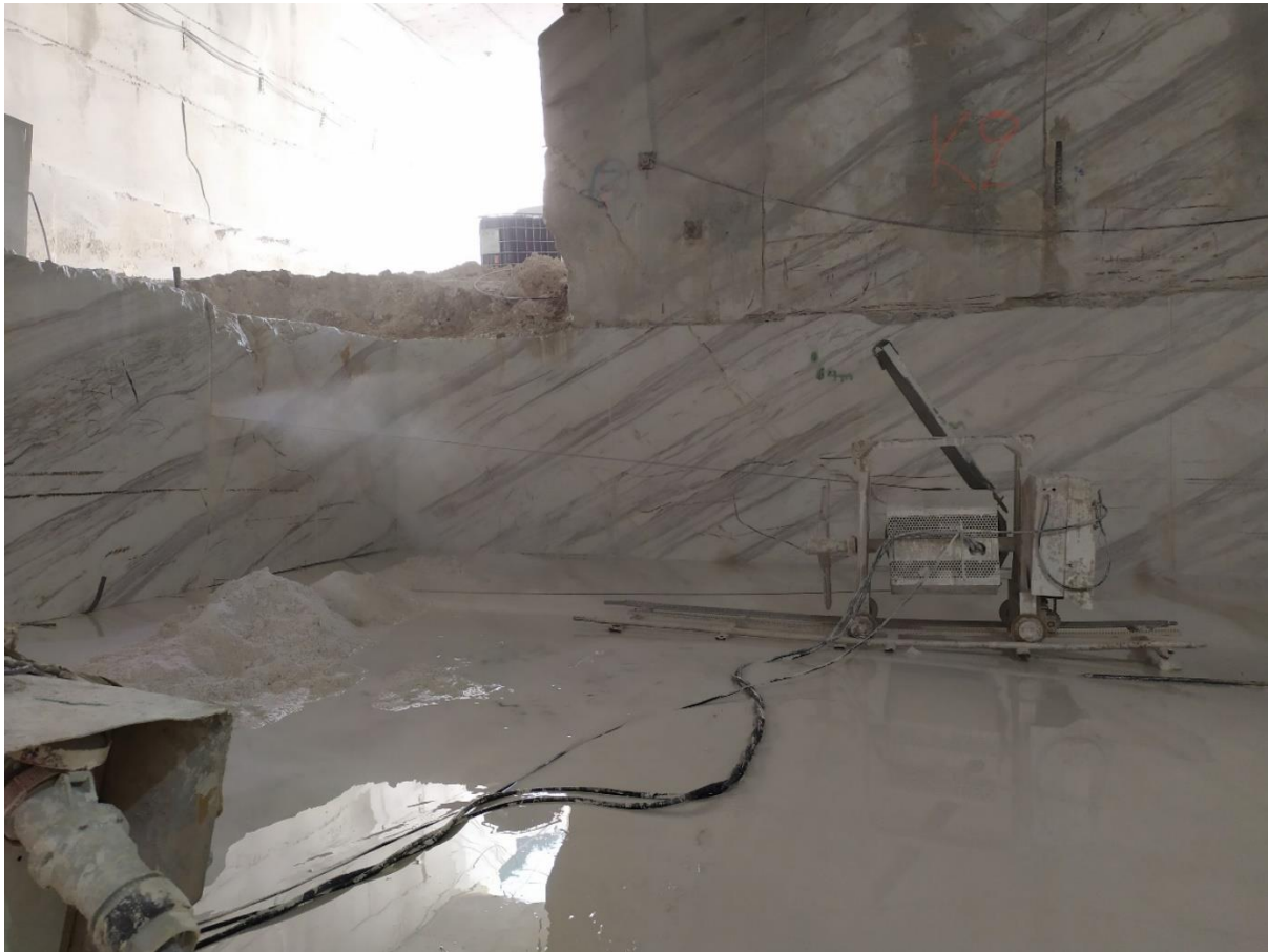
Εικόνα 1.4.1: Εξόρυξη όγκου με αδαμαντοφόρο συρματοκοπής (ΙΚΤΙΝΟΣ ΕΛΛΑΣ Α.Ε.)
