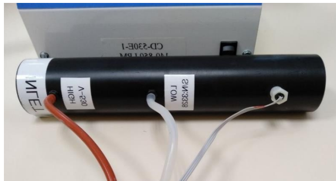
Εικόνα 4.22: Σημεία μέτρησης, της υψηλής και χαμηλής πίεσης στον Βαθμονομητή
