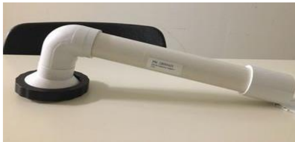
Εικόνα 4.24:Προσαρμογέας για τη μέτρηση διάταξης με φίλτρο τύπου Quartz
