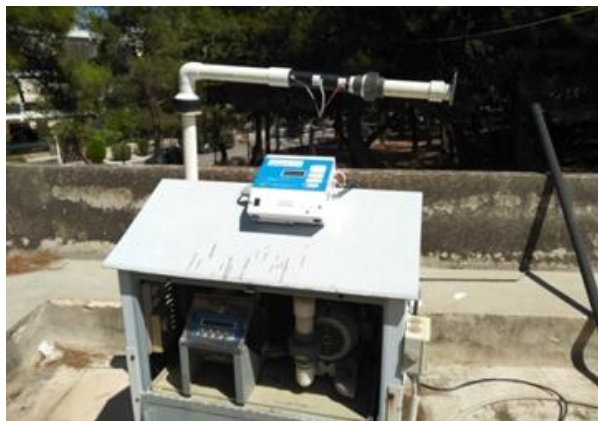
Εικόνα 4.25: Τελική συνδεσμολογία για τη βαθμονόμηση της αντλίας της ΕΕΑΕ
