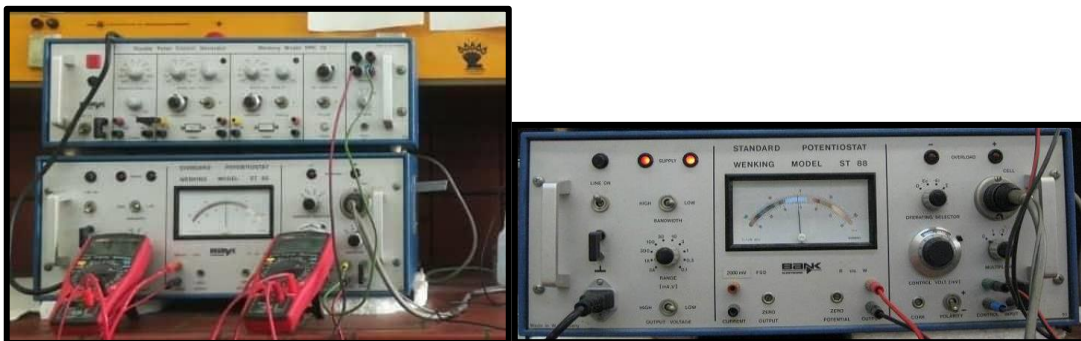
Εικόνα 6.1: Ποτενσιοστάτης της εταιρείας Wenking, μοντέλο ST 88.
