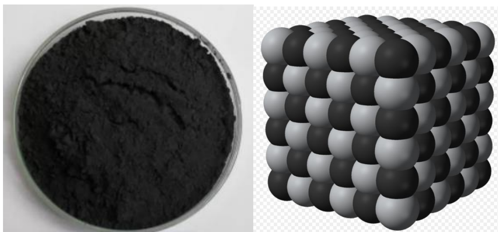
Σχήμα 2.5: Σκόνη TiC και η κρυσταλλική δομή του [26],[29].
