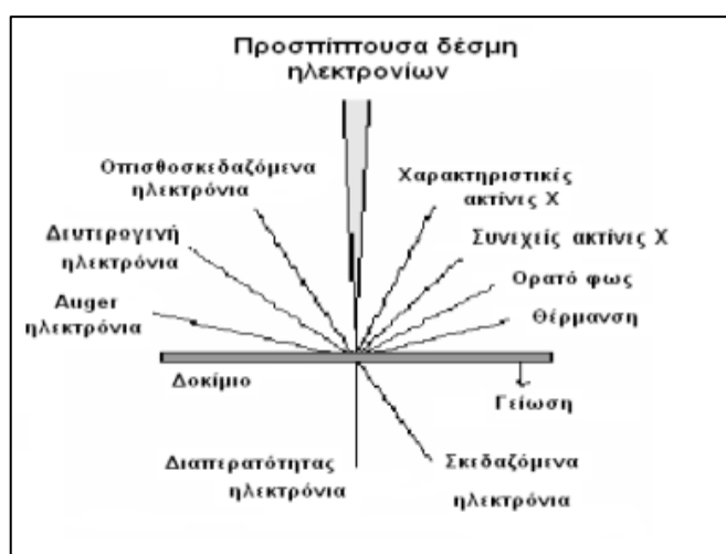
Σχήμα 7.10: Αλληλεπίδραση δέσμης ηλεκτρονίων με την ύλη [129].
