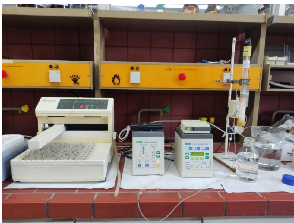
2.2.2.5 Εικόνα 11: Διάταξη καθαρισμού πρωτεΐνης με στήλη Q-Sepharose συνδεδεμένη με κλασματοσυλλέκτη.
