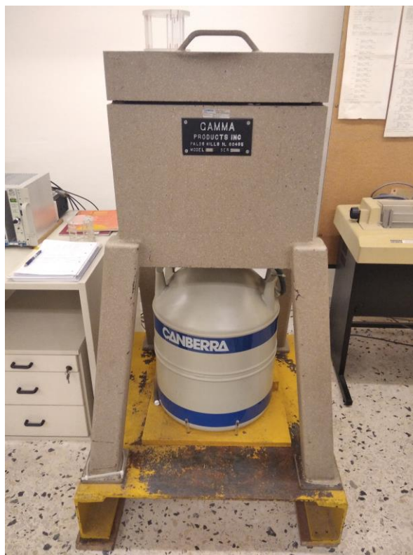
ΣΧΗΜΑ: 3.2 Άποψη του ανιχνευτή Γερμανίου απόδοσης 33.8% του ΕΠΤ-ΕΜΠ
