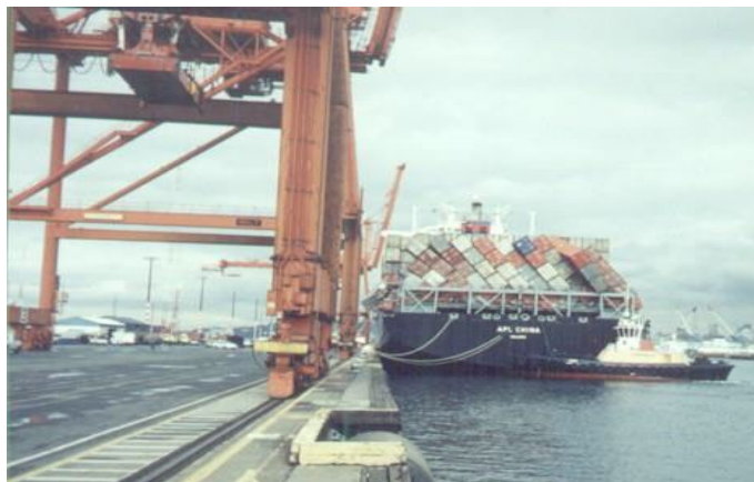
Σχήμα 2.7 : Απώλειες εμπορευματοκιβωτίων στο APL China (1998) [2]
