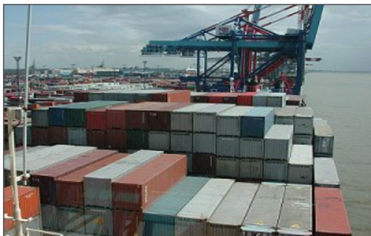
Σχήμα 2.2 : Διαμήκης διάταξη εμπορευματοκιβωτίων [4]
