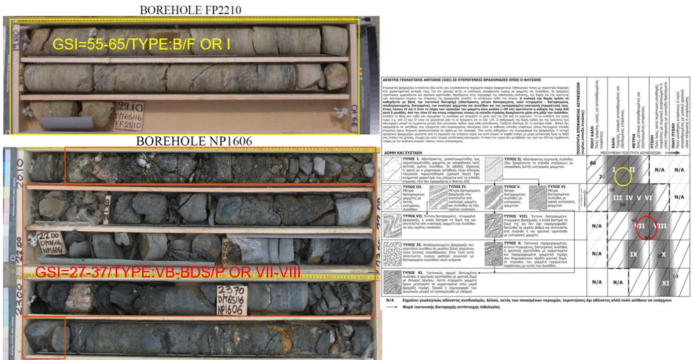
Εικόνα 4.12: Ταξινόμηση κατά GSI Ασβεστιτικού και Ιλυολιθικού Μεταψαμμίτη Κατ. Αθηναϊκού Σχιστόλιθου.
