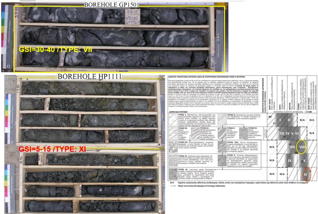
Εικόνα 4.14: Ταξινόμηση κατά GSI Εναλλαγών Μεταϊλύλιθου - Μεταψαμμίτη (80:20 – 50:50) Κατ. Αθηναϊκού Σχιστόλιθου.
