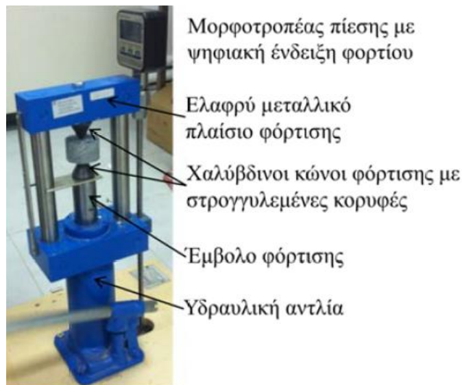
Εικόνα 2.1: Συσκευή δοκιμής σημειακής φόρτισης του Εργαστηρίου Τεχνολογίας Διάνοιξης Σηράγγων ΕΜΠ. («Εισαγωγή στη Μηχανική των Πετρωμάτων», Παύλος Νομικός)
