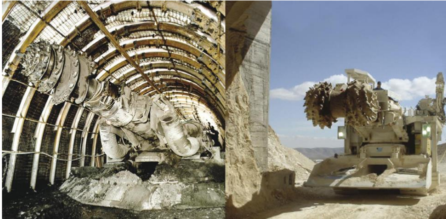
Εικόνα 2.23: Μηχανή με κεφαλή διαμήκουσ κοπής (αριστερά) και εγκάρσιας κοπής (δεξιά) (Μιχαλακόπουλος, Διαλέξεις μαθήματος «Ορυξη Υπογείων Έργων»)
