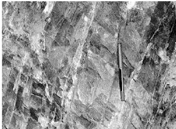
Εικόνα 4.5: Καλά αλληλένδετη και πολύ τεμαχώδης βραχώμαζα σκληρού ψαμίτη. (Πηγή: Hoek, E. et al. (1998))
