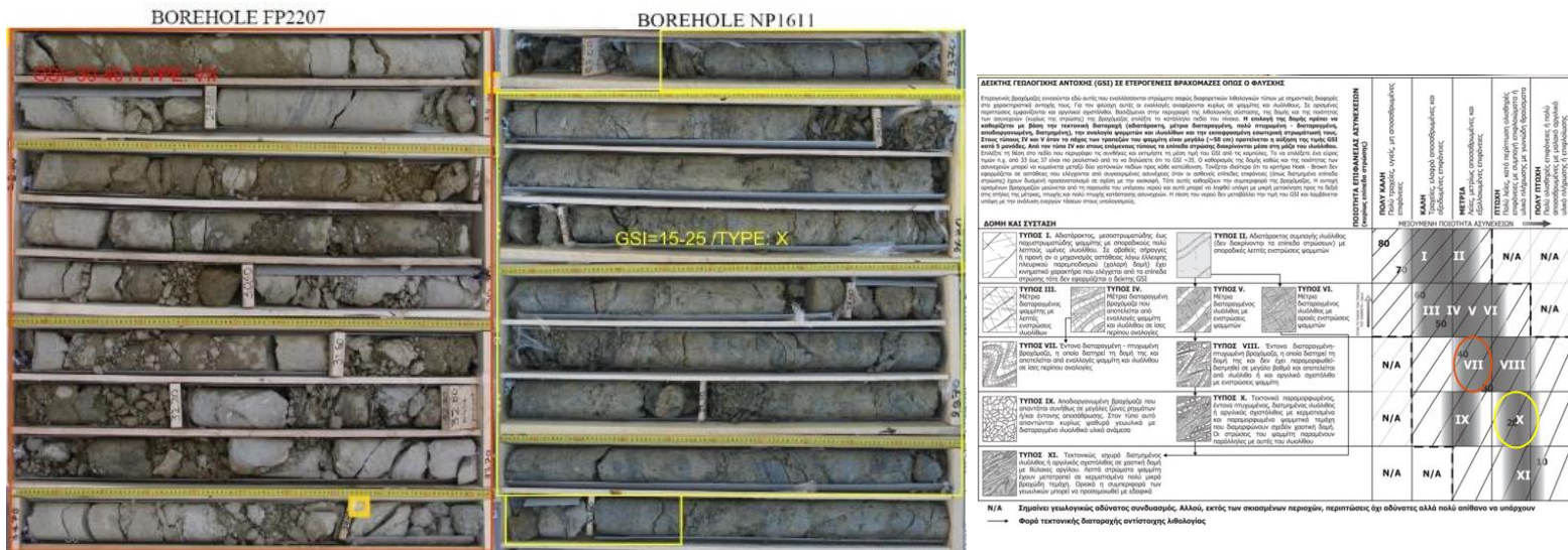
Εικόνα 4.11 Ταξινόμηση κατά GSI Εναλλαγών Μεταψαμίτη - Μεταϊλύθου (70:30 – 50:50) Αv. Αθηναϊκού Σχιστόλιθου.
