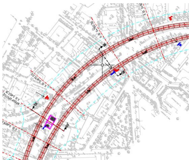
Εικόνα 28: Γεωτρήσεις στην περιοχή του φρέατος κατά μήκος της χάραξης της γραμμής του μετρό (Πηγή: Άκτωρ ΑΕ)
