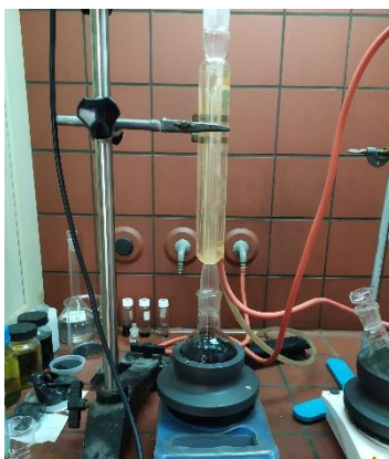
Εικόνα 10: Πειραματική διάταξη τροποποίησης CNTs με οξέα.
