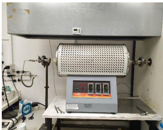
Εικόνα 8: Αντιδραστήρας – φούρνος CVD.
