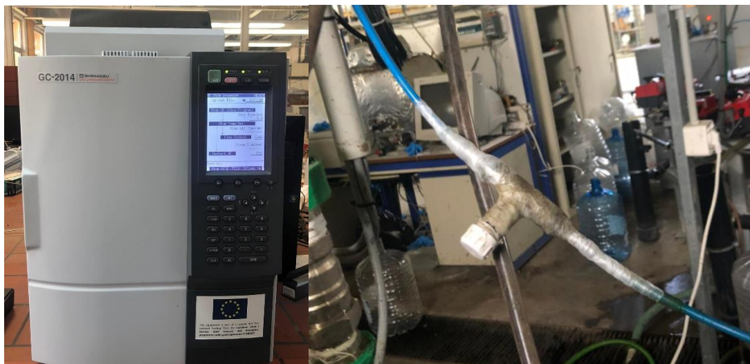
Εικόνα 4-5: α) Όργανο προσδιορισμού περιεκτικότητας μεθανίου στο βιοαέριο β) παγίδα δειγματοληψίας βιοαερίου
