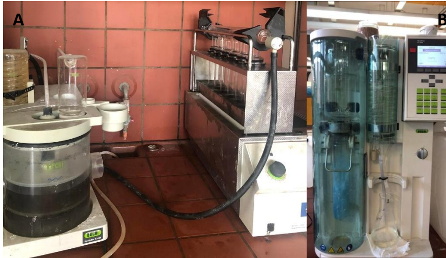
Εικόνα 4-3α) Συσκευή χώνευσης Kjeldahl β) συσκευή απόσταξης Kjeldahl
