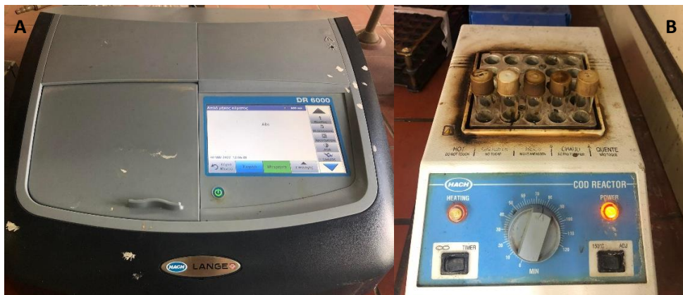
Εικόνα 4-2: α) Ηλεκτρονικό φωτόμετρο Hach για τον προσδιορισμό του COD β) Φούρνος Hach COD REACTOR 150°C
