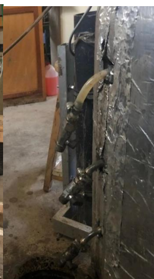
Εικόνα 5-3: α) Αναερόβιος αντιδραστήρας CSTR β) Βάνες εκροής αντιδραστήρα
