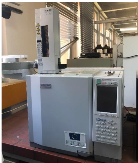
Εικόνα 4-4: Αέριος χρωματογράφος για την μέτρηση των VFAs
