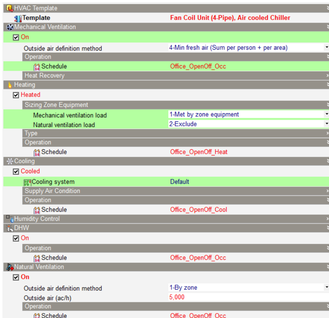
Εικόνα 1.4: Περιβάλλον Simple HVAC στο DesignBuilder
