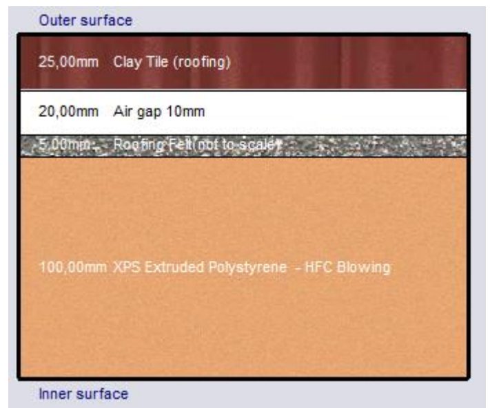
Εικόνα 4.7: Τοποθέτηση θερμομόνωσης XPS στην εξωτερική τοιχοποιία (αριστερά) και στην στέγη (δεξιά)
