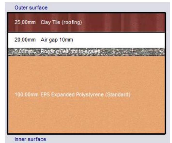
Εικόνα 4.8: Τοποθέτηση θερμομόνωσης EPS στην εξωτερική τοιχοποιία (αριστερά) και στην στέγη (δεξιά)
