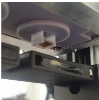
Εικόνα 55: Νέα κατασκευή δότη, που παρέχει τη δυνατότητα εκτύπωσης στο εσωτερικό των θαλάμων των μικροροϊκών πλατφόρμων.
