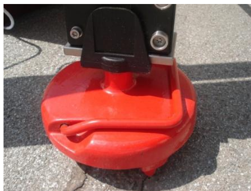
Εικόνα 2.27: Χωροσταθμική βάση ή χελώνα που χρησιμοποιήθηκε για την έδραση της σταδίας στο εξωτερικό πείραμα.
