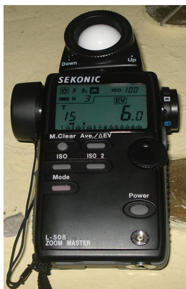
Εικόνα 2.23: Το φωτόμετρο Zoom-Master L-508 που μετράει την ένταση του φωτός.
