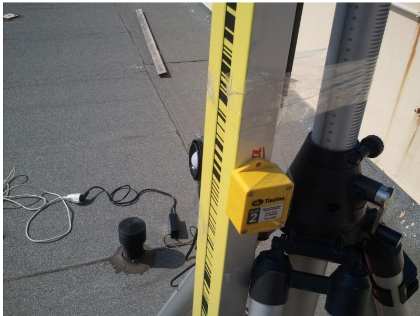
Εικόνα 2.18: Η τοποθέτηση του tinytag plus 2 TGP-4500 πάνω στη σταδία για την καταγραφή των μετρήσεων.
