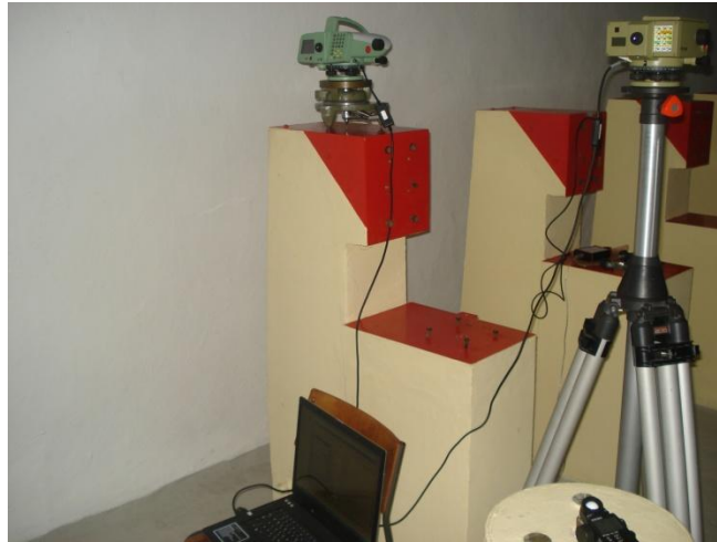
Εικόνα 2.24: Η τοποθέτηση των δύο χωροβατών στο τούνελ της σχολής ATM.
