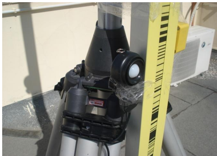
Εικόνα 2.22: Τοποθέτηση φωτομέτρου HD450 πάνω στη σταδιά.
