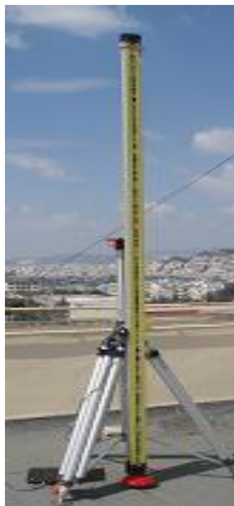
Εικόνα 2.13: Η σταδία Invar GPCL3 με bar code τοποθετημένη σε χωροσταθμική βάση (χελώνα), στηριγμένη πάνω σε ένα τρίποδα Βιομηχανικής Γεωδαισίας.
