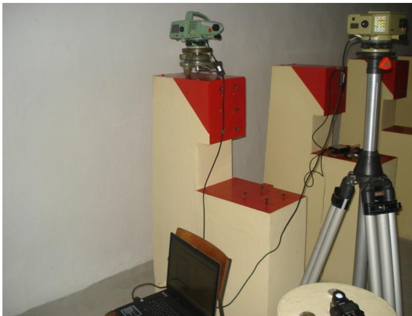
Εικόνα 3.1: Πάνω φαίνεται το τούνελ, η τοποθέτηση της σταδίας και του φακού ρυθμιζόμενης έντασης σε θέση για διαχεόμενο φωτισμό, ενώ κάτω φαίνονται οι δύο χωροβάτες, ο υπολογιστής το θερμόμετρο και η συνδεσμολογία τους.
