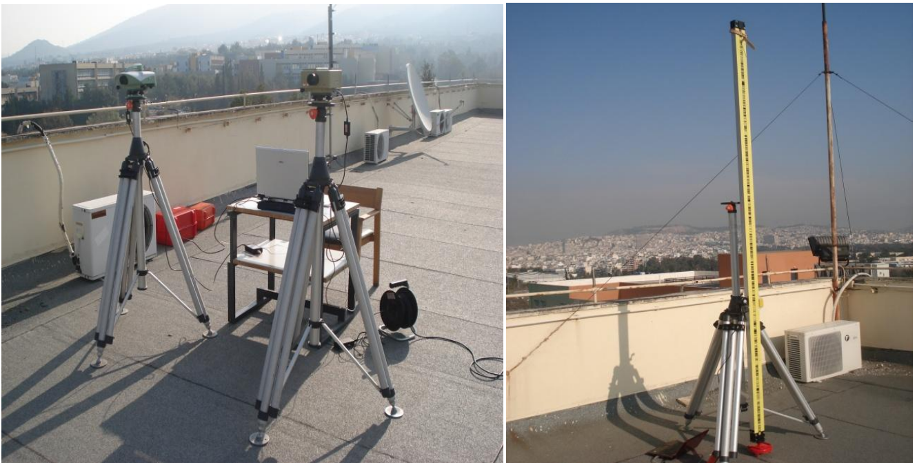
Εικόνα 4.1: Αριστερά φαίνονται , η τοποθέτηση των δυο χωροβατών και του ενός θερμομέτρου και η συνδεσμολογία τους με τον υπολογιστή, ενώ δεξιά φαίνονται η σταδία με τη στήριξή της, ο μικρότερος υπολογιστής το θερμοόμετρο και το φωτόμετρο και η συνδεσμολογία τους.
