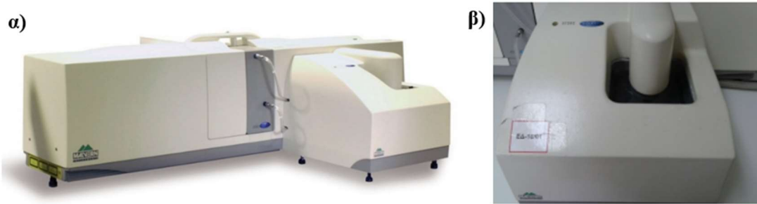
Εικόνα 55: α) Lazer κοκκομετρικός αναλυτής Hydro 2000G της Malvern [92], β) Θάλαμος εισαγωγής δείγματος προς μέτρηση
