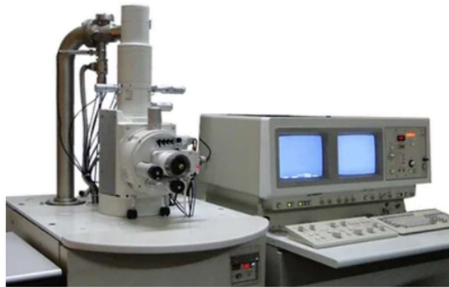
Εικόνα 60: Ηλεκτρονικό Μικροσκόπιο Σάρωσης JEOL JSM-6300 της JEOL
