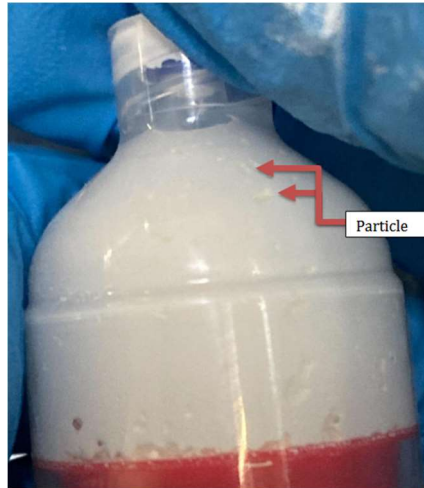
Εικόνα 68: Προσπάθεια ανάμειξης του φωτοεκκινητή (TPO), 6h πριν την εκτύπωση. Παρουσιάζονται τα σωματίδια TPO, τα οποία δεν έχουν διαλυθεί στο αιώρημα S 15 .
