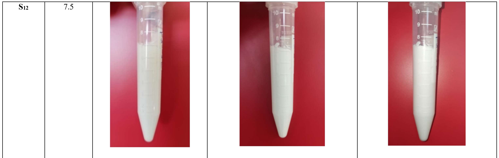
Εικόνα 65: Καθίζηση των υδατικών αιωρημάτων 3YSZ, με 60%wt στερέα (S 7 -S 12 ), Solsperse 40000 1% σε διάφορες τιμές pH, μετά από: α) 1 ημέρα, β) 30 ημέρες, γ) 90 ημέρες
