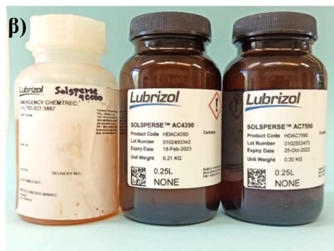
Εικόνα 47: Διασπορείς: α) Darvan C (Vanderbilt Minerals, LLC), β) Solsperse 40000, Solsperse AC 4390, Solsperse AC 7590 (Lubrizol)
