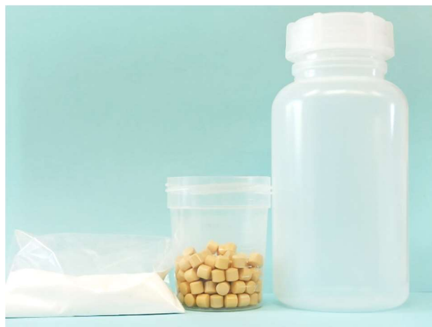
Εικόνα 49: Πούδρα ζirkονίας TZ-3Y-E, σφαιρίδια ζirkονίας και εργαστηριακό δοχείο (LLG-wide-neck bottle).
