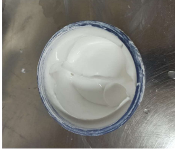
Εικόνα 51: Πάστα μετά από ανάμειξη σε vacuum mixer
