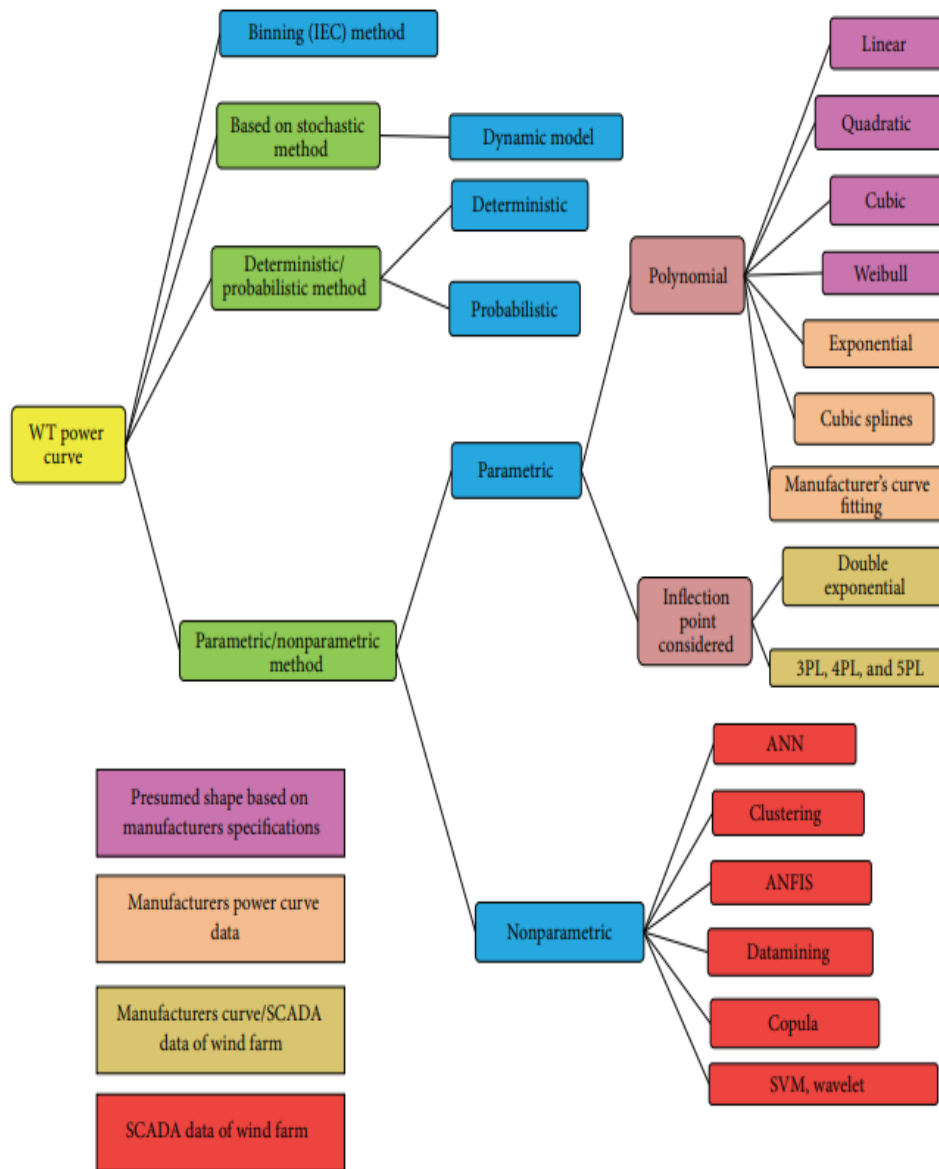
Εικόνα 35: Μοντέλα καμπύλης ισχύος ανεμογεννητριών (Πηγή: A Critical Review on Wind Turbine Power Curve Modelling Techniques and Their Applications in Wind Based Energy Systems- Vaishali Sohoni, S. C. Gupta, and R. K. Nema)
