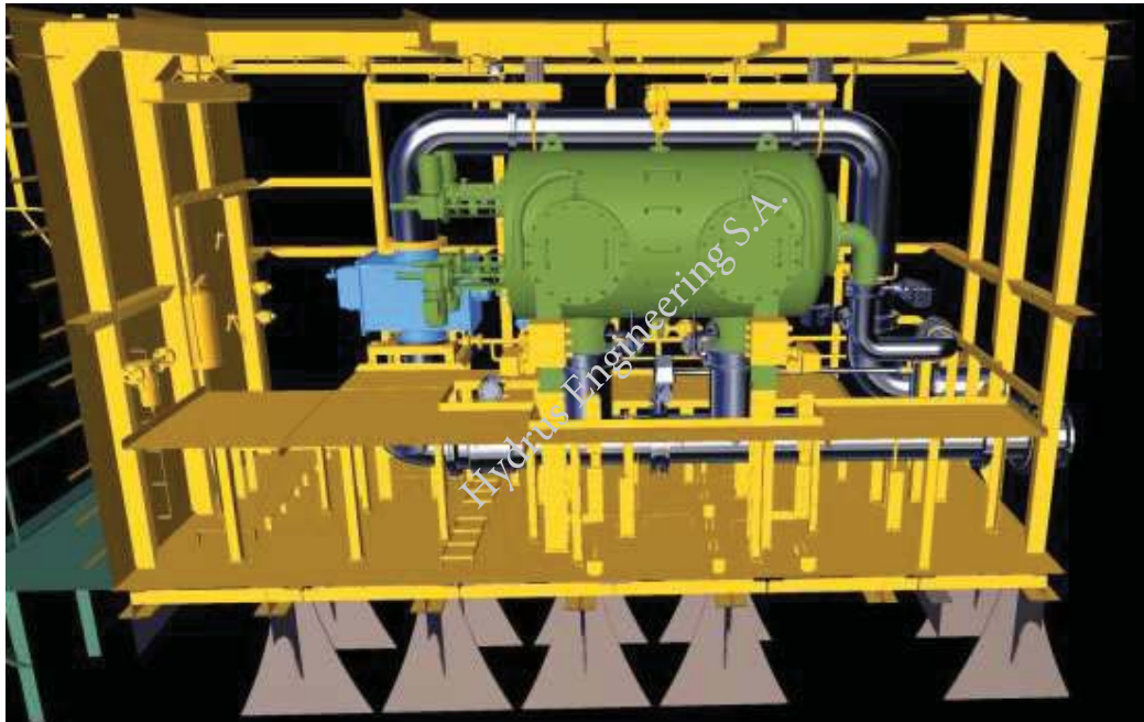
Εικόνα 6.14: Εσωτερική διάταξη του εξοπλισμού για το BWTS P1000EX Σύστημα στο πρόγραμμα Navisworks (Hydrus Engineering S.A.)
