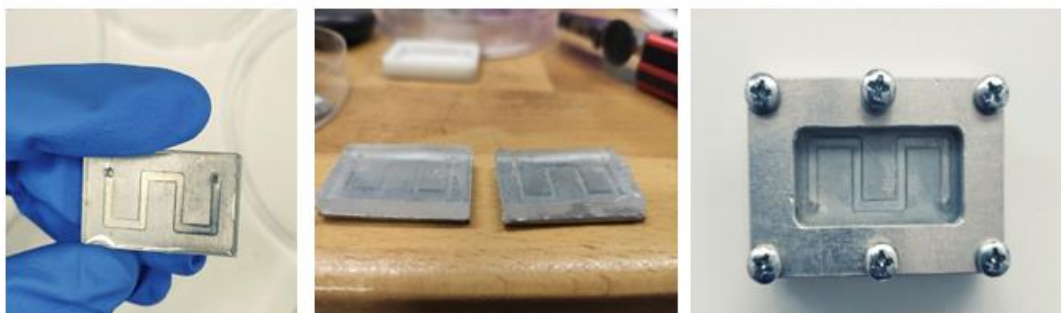
Σχήμα 2.5.2.1: Εικόνες από το μικρο-κανάλι που είναι σχηματισμένο στο υπόστρωμα ZnO με κάλυμμα από PDMS και τοποθέτηση του σε chipholder για μηχανική συγκράτηση.
