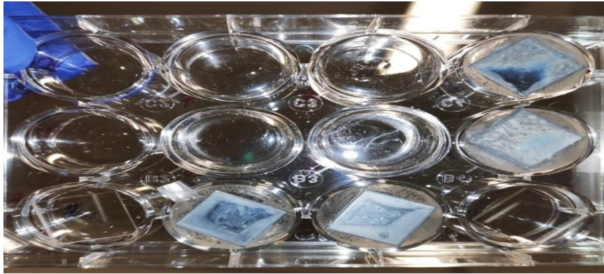
Σχήμα 3.2.2.7: Επιφάνειες PMMA, επίπεδου Zn και εγχαραγμένου ZnO σε plate με 2ml διαλύματος βακτηριακών κυττάρων σε διάλυμα NaCl 0.9% μετά την παραμονή στο κλίβανο επώασης. Το θολό εναιώρημα που προκύπτει είναι εμφανές στις επιφάνειες του υποστρώματος ZnO.
