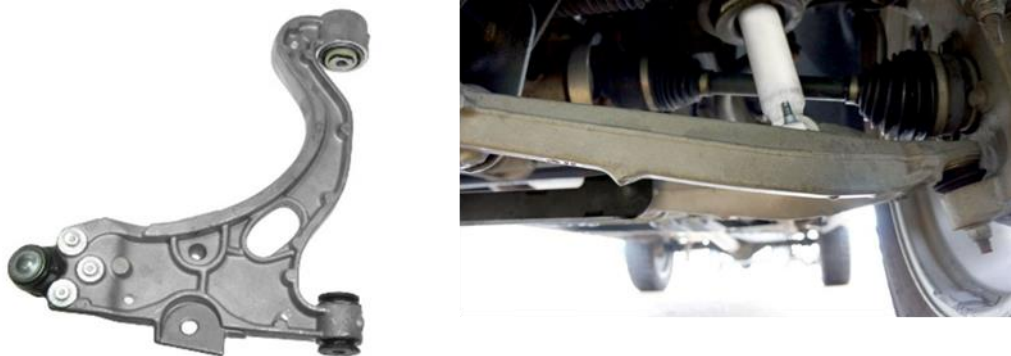
Εικόνα 3.6: Ψαλίδια χυτού αλουμινίου (α) ενιαίο, (β) σε κομμάτια [26]
