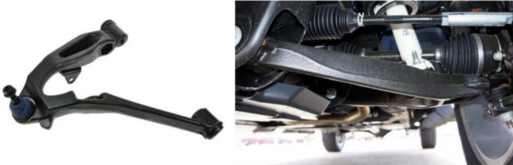
Εικόνα 3.5: Ψαλίδια χυτοσιδήρου (α) ενιαίο, (β) σε κομμάτια [26]
