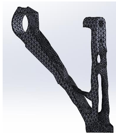
Σχήμα 4.31: Γεωμετρικό μοντέλο TB5 από χάλυβα ASTM A36 μπροστινή (α) και πλάγια (β) όψη
