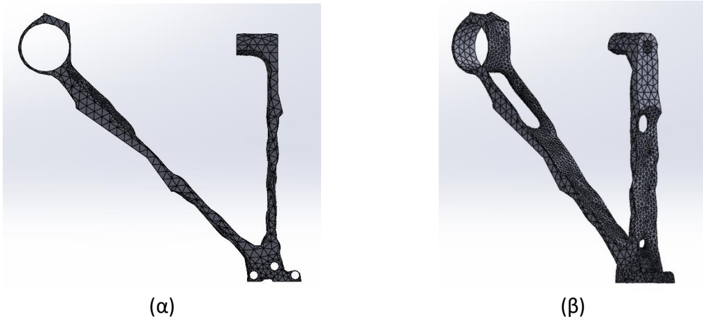
Σχήμα 4.13: Γεωμετρικό μοντέλο TB5 από κράμα αλουμινίου μπροστινή (α) και πλάγια (β) όψη
