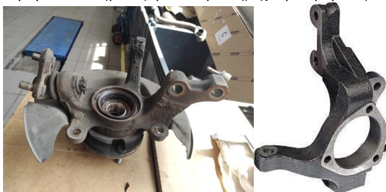
Εικόνα 3.3: Αρθρώσεις οδήγησης (steering knuckles)
