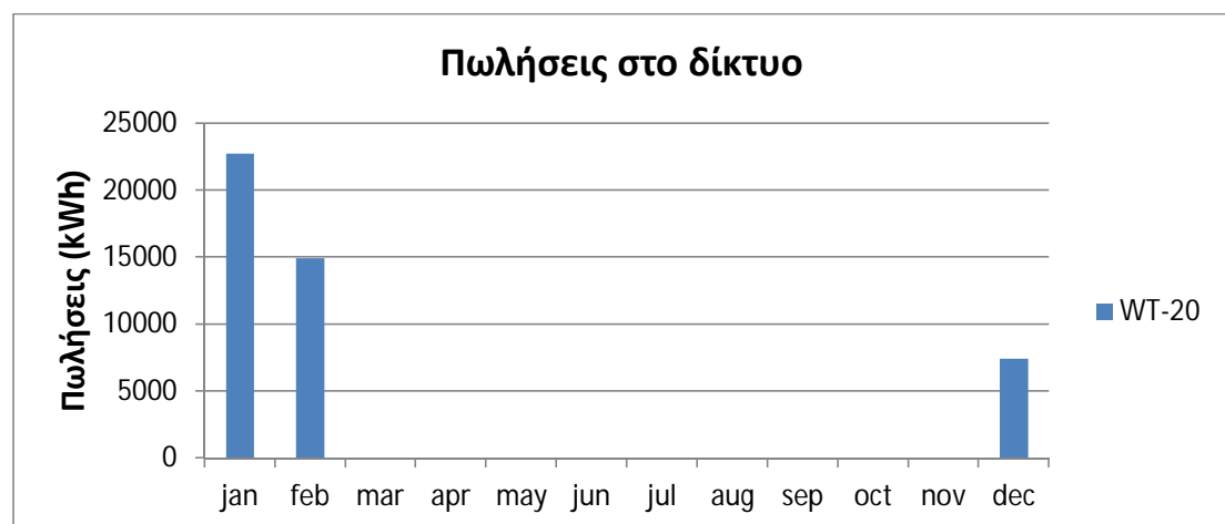
Διάγραμμα 2.19 : Συνολικές πωλήσεις ενέργειας στο δίκτυο για το σενάριο "der" και το τιμολόγιο της ΔΕΗ
