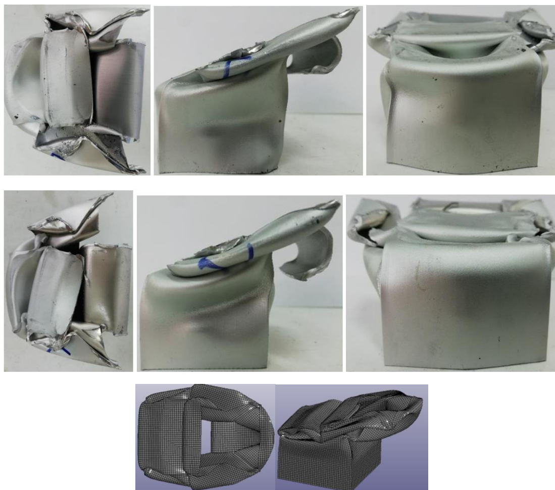
Σχήμα 58: Τελική εικόνα κατάρρευσης δοκιμίου σε 20° (πάνω: πειράματα 5α-5β, κάτω: προσομοίωση)
