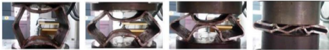
Σχήμα 19: Εγκάρσια φόρτιση λεπτότοιχου κελύφους αλουμινίου [34]
