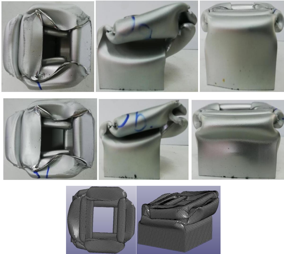
Σχήμα 52: Τελική εικόνα κατάρρευσης δοκιμίου σε 10^\circ (πάνω: πειράματα 3α-3β, κάτω: προσομοίωση)
