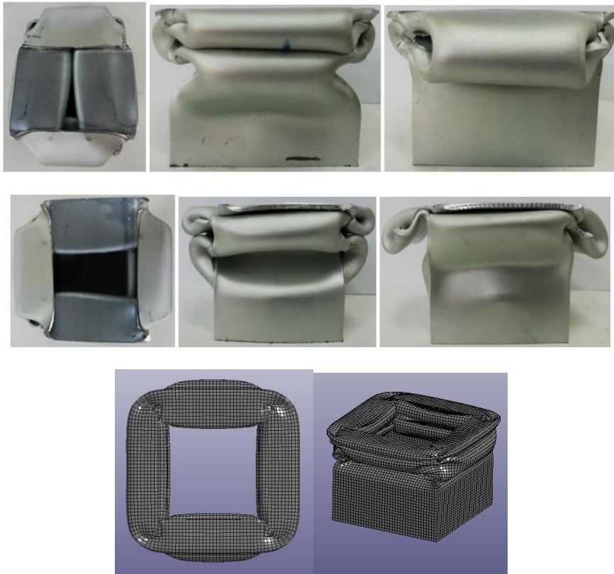
Σχήμα 46: Τελική εικόνα κατάρρευσης δοκιμίου σε 0^\circ (πάνω: πειράματα 1α-1β, κάτω: προσομοίωση)
