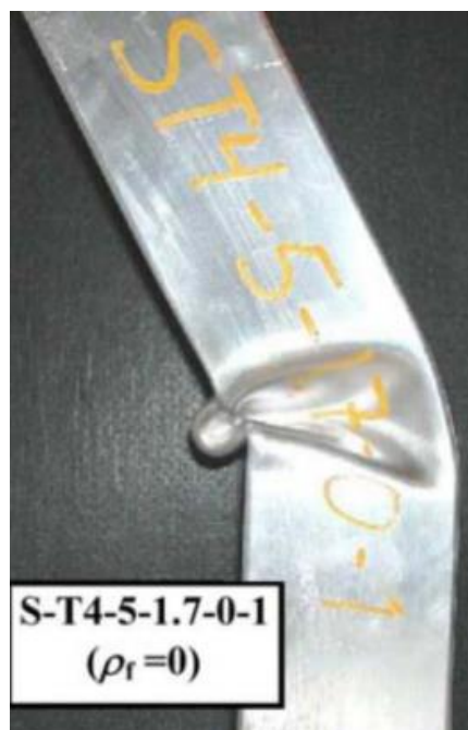
Σχήμα 8: Κατάρρευση κατά λυγισμό Euler
