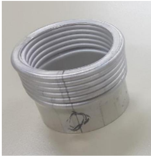
Σχήμα 4: Αξονοσυμμετρικός τρόπος κατάρρευσης
