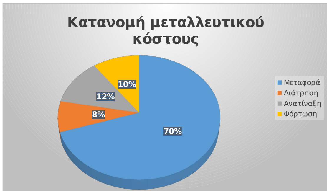
Εικόνα 15: Διάγραμμα : Απεικόνιση της κατανομής του κόστους στις διάφορες λειτουργίες ενός μεταλλείου (Bagherpour et al. 2007)
