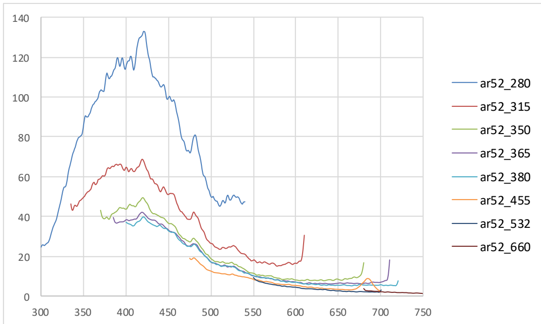
Γράφημα 17: Φάσμα φθορισμού του δείγματος χαρτιού AR52, έπειτα από 52 ημέρες επεξεργασίας ( 105^{\circ}C ). Με διαφορετικό χρώμα εμφανίζονται τα διαφορετικά μήκη κύματος διέγερσης.
