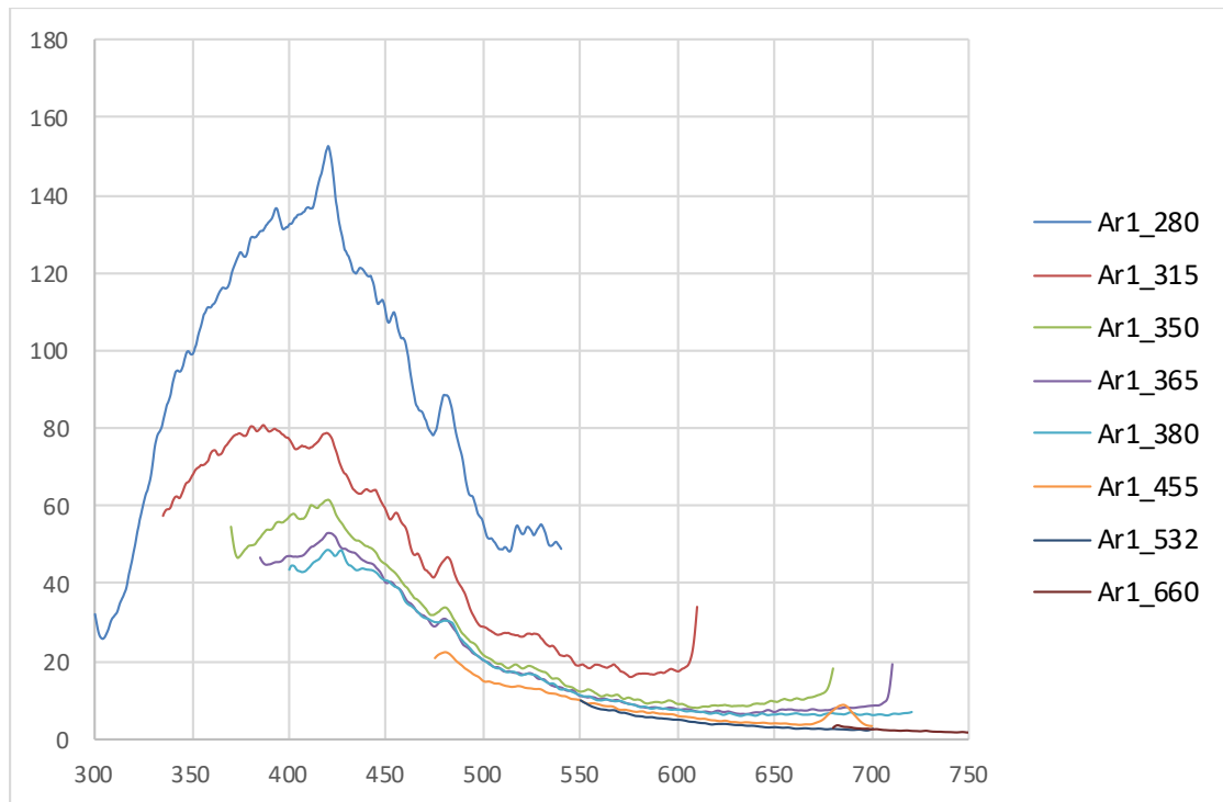
Γράφημα 2: Φάσμα φθορισμού του δείγματος χαρτιού AR1, έπειτα από 1 ημέρα επεξεργασίας ( 90^{\circ}C , 77\%RH^* , sv ). Με διαφορετικό χρώμα εμφανίζονται τα διαφορετικά μήκη κύματος διέγερσης.
