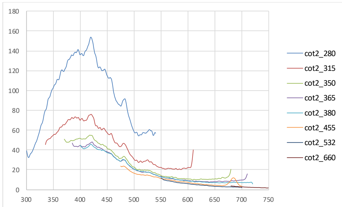
Γράφημα 10: Φάσμα φθορισμού του δείγματος χαρτιού COT2, έπειτα από 4 ημέρες επεξεργασίας ( 90^{\circ}C , 77\%RH^* , sv ). Με διαφορετικό χρώμα εμφανίζονται τα διαφορετικά μήκη κύματος διέγερσης.
