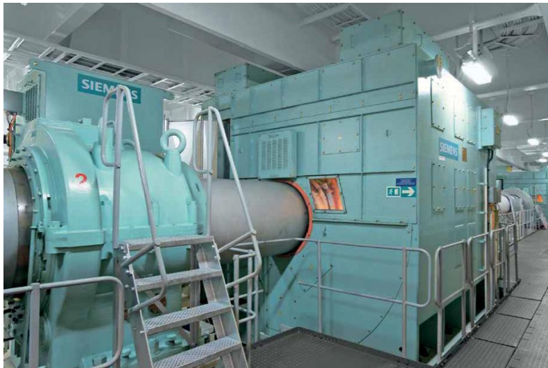
Σχήμα 2.13: Μεγάλη εγκατάσταση PTO SMG/CFE σε μεγάλο σκάφος εμπορευματοκιβωτίων. (MAN Diesel&Turbo, 2020)
