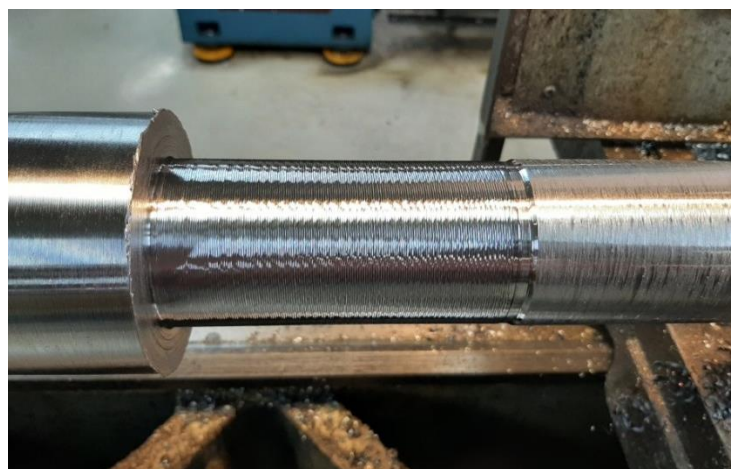
Εικόνα 2 - 6 : Κακή τραχύτητα σε ΤΕ από τα πειράματα της διπλωματικής
