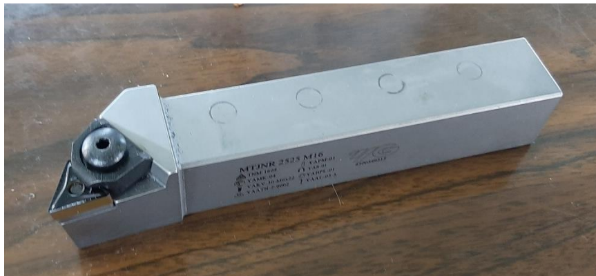
Εικόνα 4 - 22 : Κοπτικό εργαλείο TNMG160408-UG YG3020
