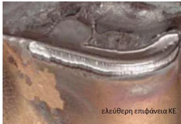
Εικόνα 2 - 7 : Φθορά πεδίου στο ΚΕ (Sandvik Coromant)
