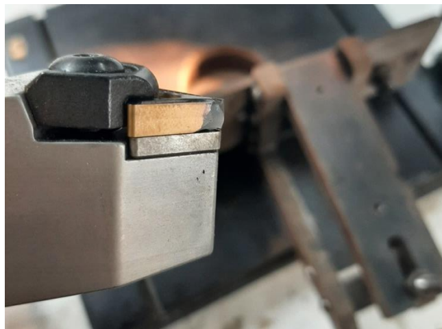
Εικόνα 2 - 9 : Θραύση του ΚΕ στα πειράματα της διπλωματικής
