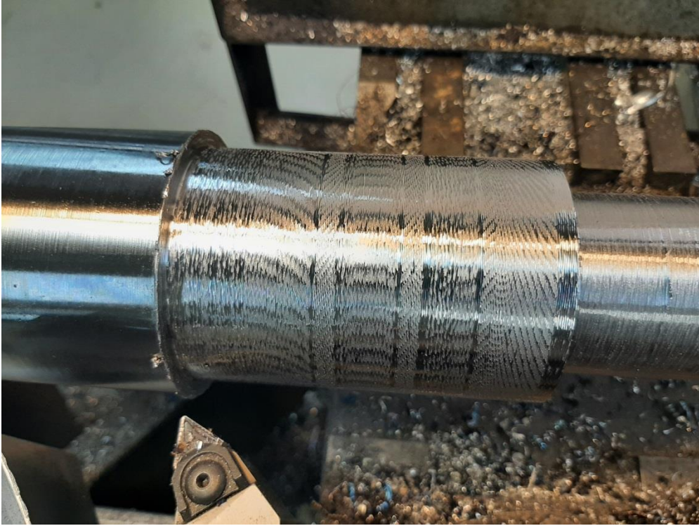
Εικόνα 4 - 27 : ΤΕ με κακή τραχύτητα – μετά τη δοκιμή 9
