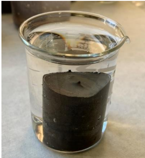
Εικόνα 266 : Ωρίμανση δοκιμίου σε νερό.
