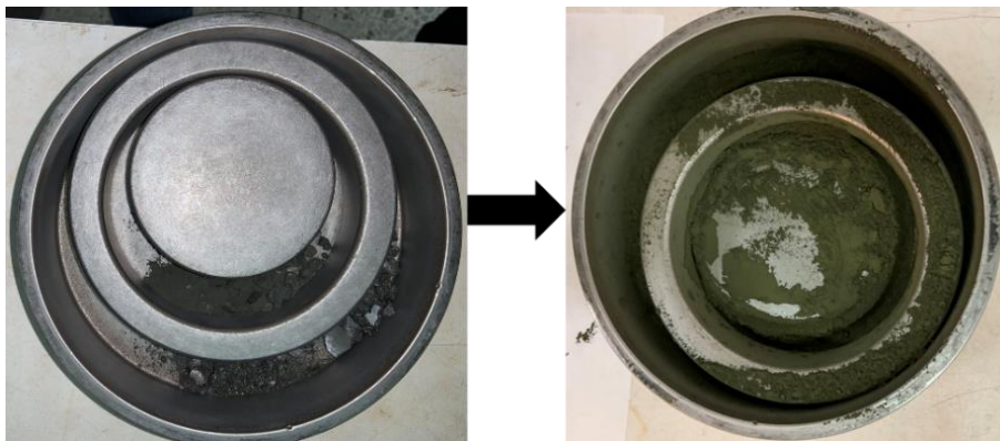
Εικόνα 23 : Δείγμα πριν (αριστερά) και μετά (δεξιά) τη λειοτρίβηση σε δισκόμυλο.
