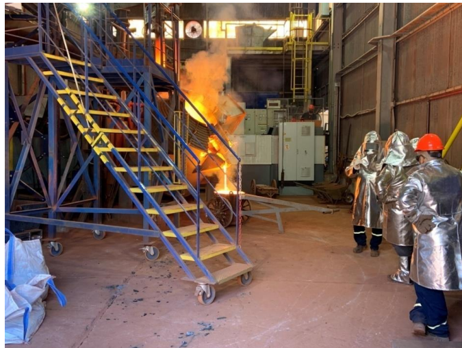
Εικόνα 12: Ανάκτηση σιδήρου από κατάλοιπα βωξίτη με τη χρήση φούρνου ηλεκτρικού τόξου στο Αλουμίνιο της Ελλάδος (Φωτογραφία Αρχείου).
