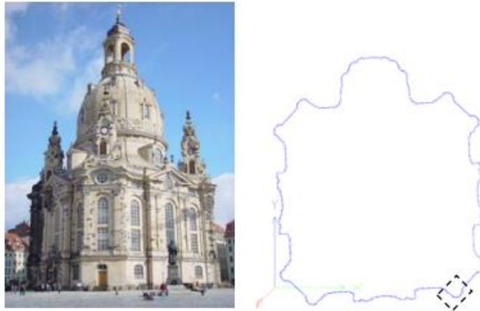
Εικόνα 1: Πρακτική εφαρμογή του αλγορίθμου στην Frauenkirche. Αριστερά το μνημείο στη Δρέσδη, δεξιά μια οριζόντια τομή (Bienert, 2008)
